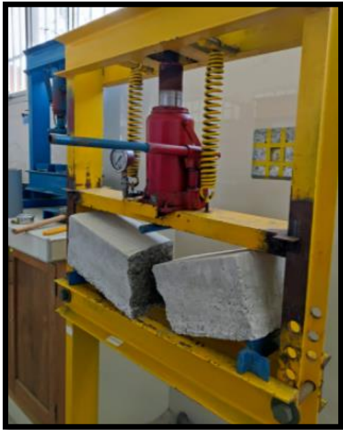
Ruptura de Vigas
