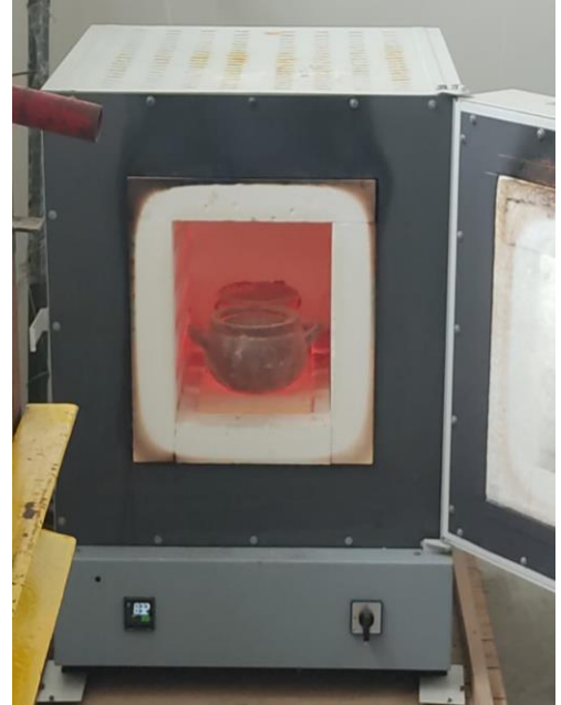
Calcinación de la Tierra de diatomea a 750 °C
