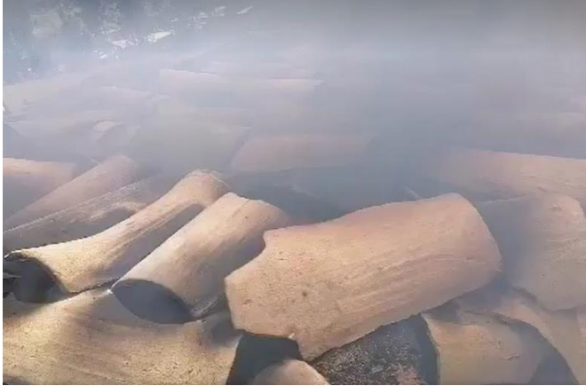
Quemado de las tejas en un horno artesanal por un periodo de tiempo de 8 horas.
