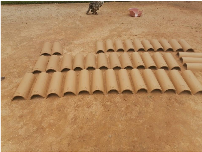
Elaboración de las tejas con 0%, 5%, 10% y 15% de tierra de diatomea
