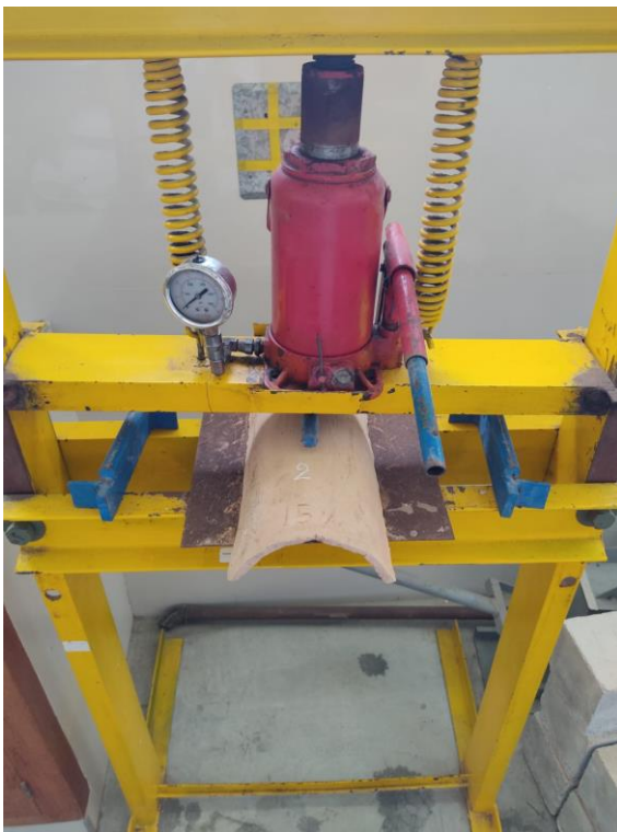
Ensayo de resistencia a la flexión a través de una prensa hidráulica modificada
