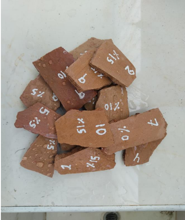
Probetas de 0%, 5%, 10% y 15% de tierra de diatomea para ensayos de densidad
