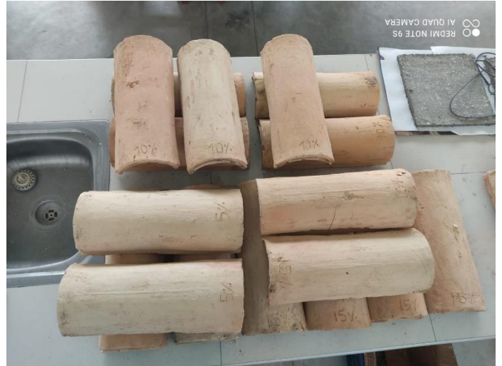
Probetas de 0%, 5%, 10% y 15% de tierra de diatomea para ensayos de resistencia a la flexión
