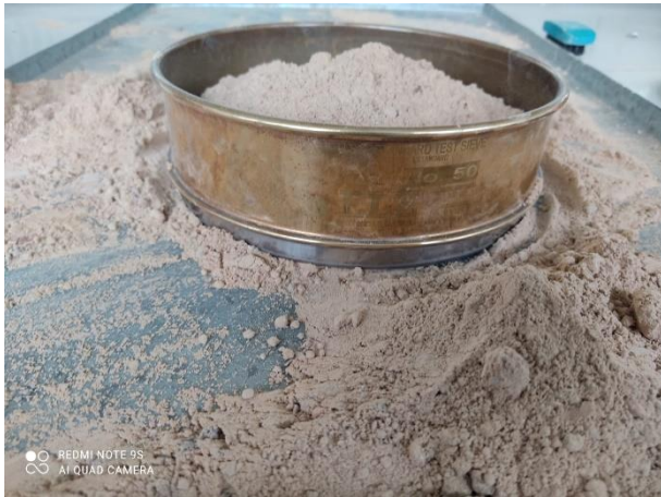
Tamizado de la Tierra de diatomea calcinada por medio del tamiz N° 50
