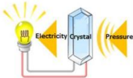
Figura 3 Generación de electricidad mediante disco piezoeléctrico
