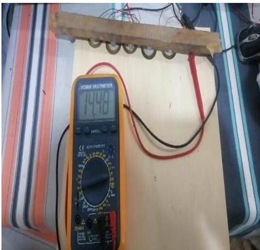
Figura 50 Conexión y medición en circuito paralelo de los discos piezoeléctricos.
