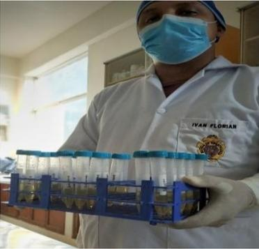
Figura 14: Tubos con 5 mL de tripsina al 0.25% en EDTA conteniendo bloques de cemento listos para su incubación a 37°C por 45 minutos
