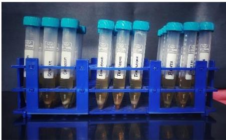
Figura 19: Tubos con 5 mL de tripsina al 0.25% en EDTA conteniendo bloques de cemento luego de someterlos a incubación a  $37^{\circ}\text{C}$  por 45 minutos.
