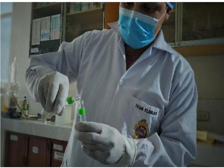
Figura 11: Contaminación de un bloque de cemento al agregar la suspensión bacteriana de *Streptococcus mutans* ATCC 25175 con una concentración de  $1.5 \times 10^8$  bact/mL.
