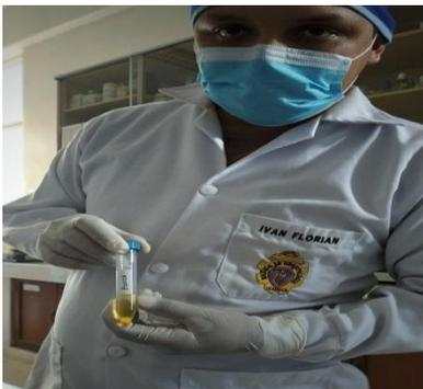
Figura 13: Tubo con 5 mL de tripsina al 0.25% en EDTA conteniendo un bloque de cemento.
