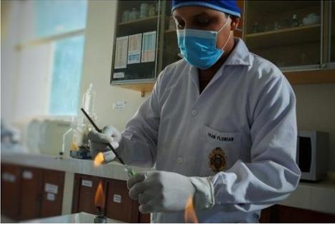
Figura 10: Preparación de la suspensión bacteriana de *Streptococcus mutans* ATCC 25175 con una concentración de  $1.5 \times 10^8$  bact/mL.
