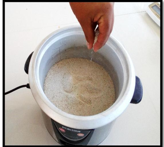
Figura 10: preparando el polvillo de arroz para la cocción en la olla arrocera y obtener el aglomerante.
