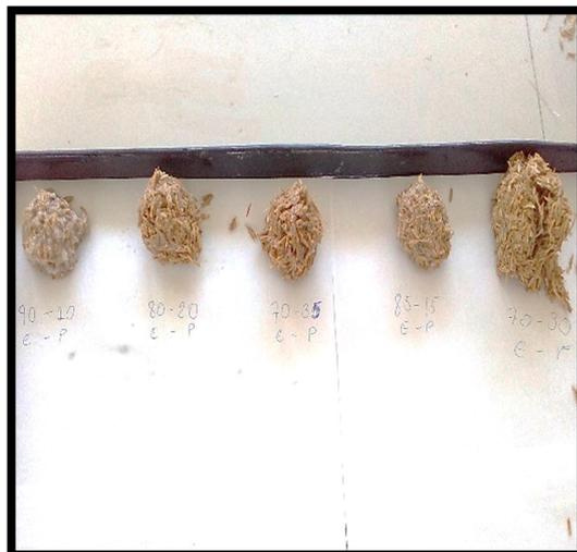
Figura 15: proporciones de ensayo para determinar el aglomerante.
