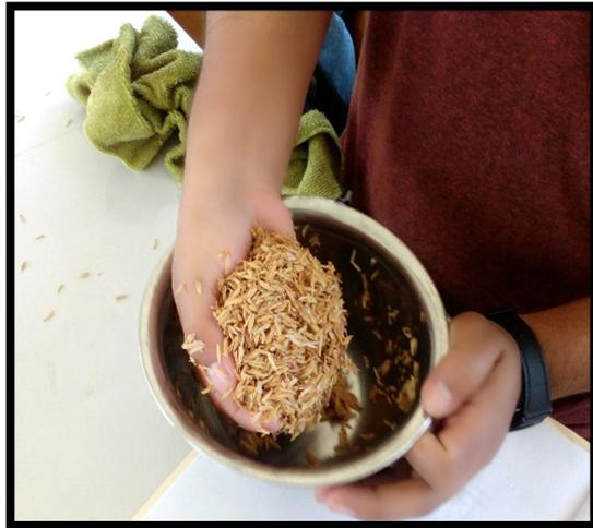
Figura 13: mezcla del aglomerado y la cascarilla de arroz.
