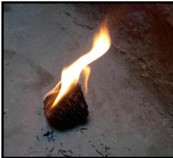
Figura 23: un promedio de trece minutos es lo que dura la incineración de la briqueta.
