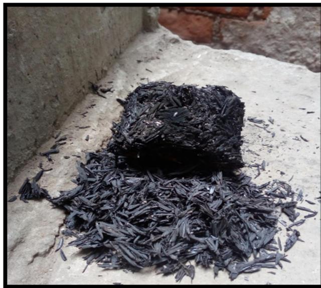
Figura 26: cenizas después de la incineración de la briqueta.
