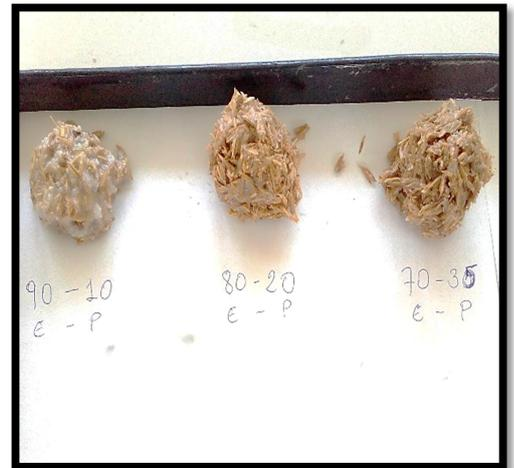
Figura 14: proporciones de ensayo para determinar el aglomerante.
