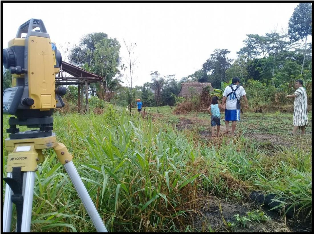
**Figura 15:** Levantamiento topográfico de red de distribución.
