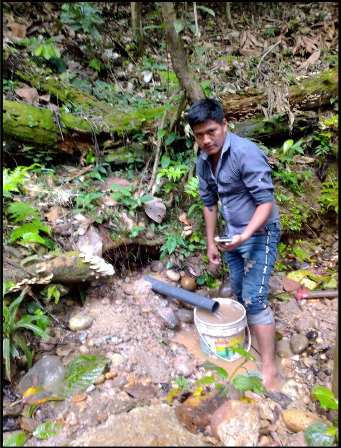
**Figura 20:** Aforo del caudal de la fuente.
