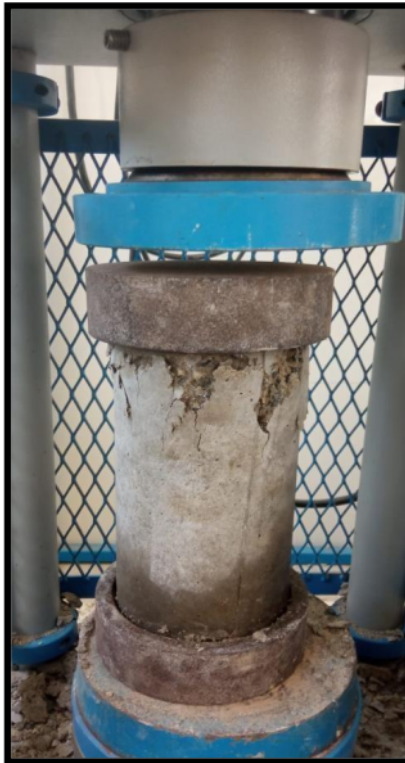
Ensayo a la compresión de probetas de concreto
