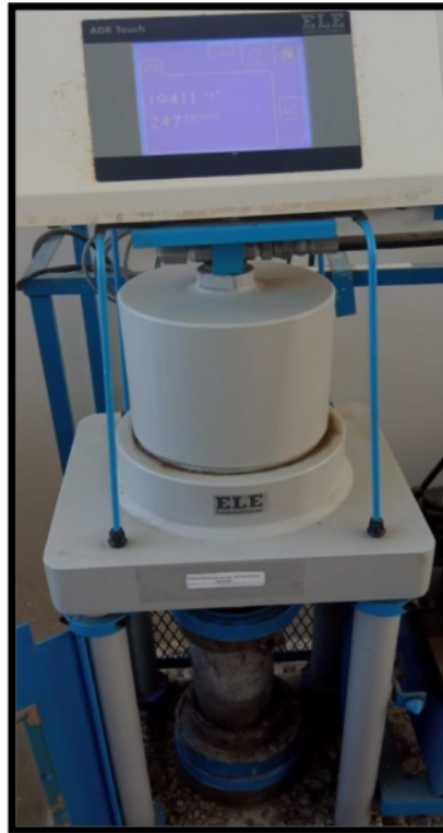
Ensayo a la compresión de probetas de concreto
