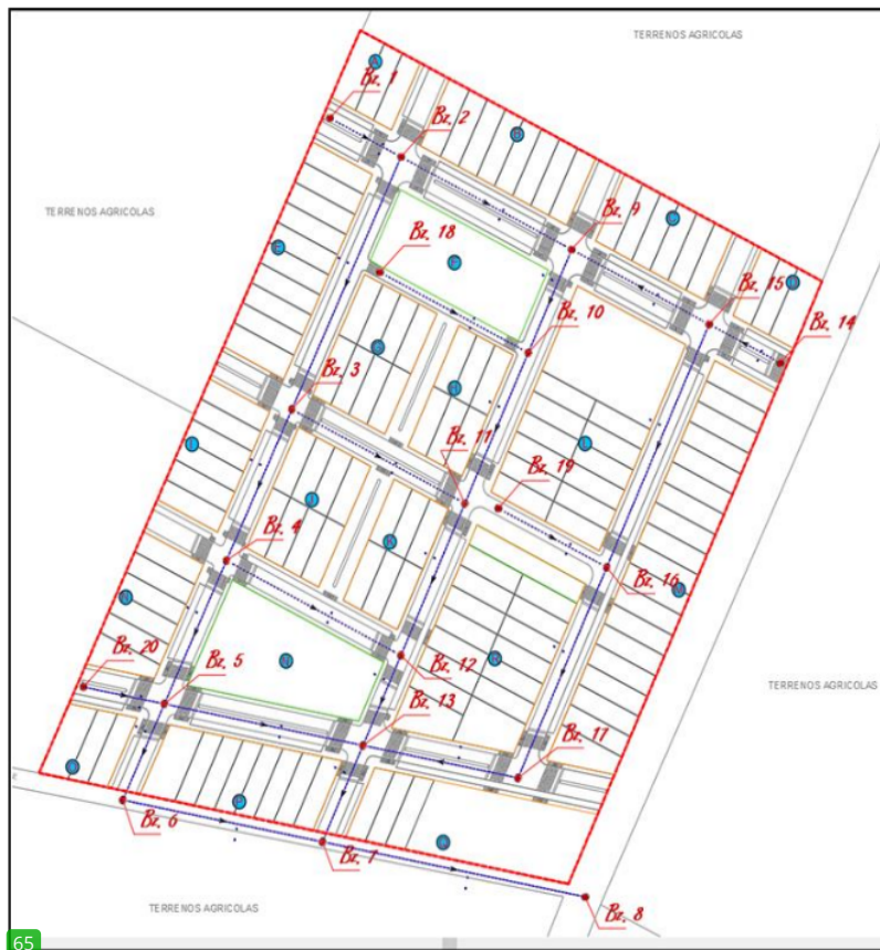
Figura: N°30. Modelamiento del sistema de alcantarillado.
