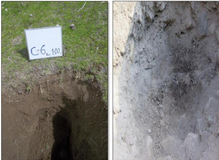
**Fotografía N° 18.** Calicata 06A – 06B red de distribución y línea de conducción
