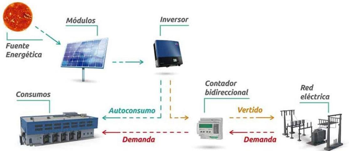
Nota. Tomado de *Configuración de instalaciones solares fotovoltaicas*, por Cantos S. Julián, 2016. <https://almerichestudio.es/funcionamiento-y-componentes-de-una-instalacion-fotovoltaica-conectada-a-red/>
