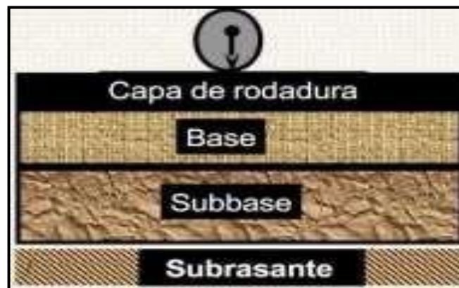
Figura 1. Detalle del pavimento flexible. Fuente: Sangama (2018)
