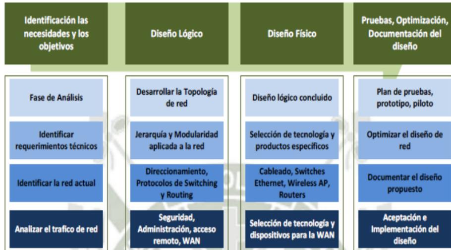
*Nota:* La figura muestra la estructura del modelo tales como son: identificación de necesidades y objetivos, diseño lógico, diseño físico, pruebas, optimización, documentación de diseño.
