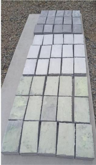
Ensayo de la fotoluminiscencia con el adoquín con sulfuro de zinc dopado con cloruro de cobre
