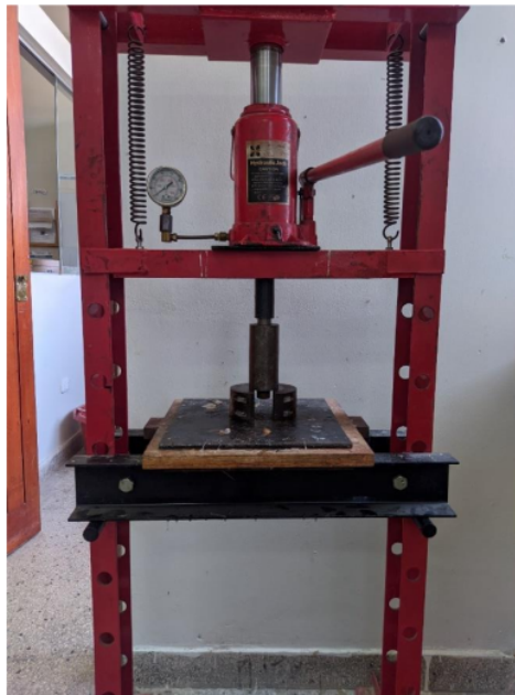
Aplicación de prensa hidráulica a pastas
