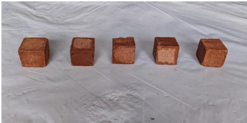
Morteros de grupo experimental con \text{Na}_2\text{SiO}_3 5M
