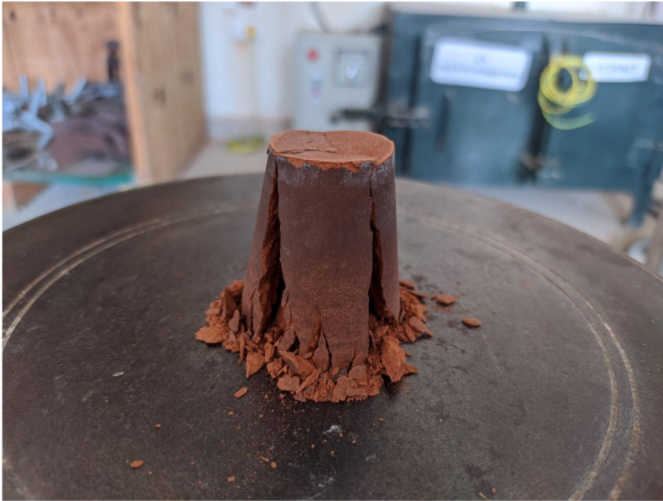
Falla de pasta por ensayo de compresión
