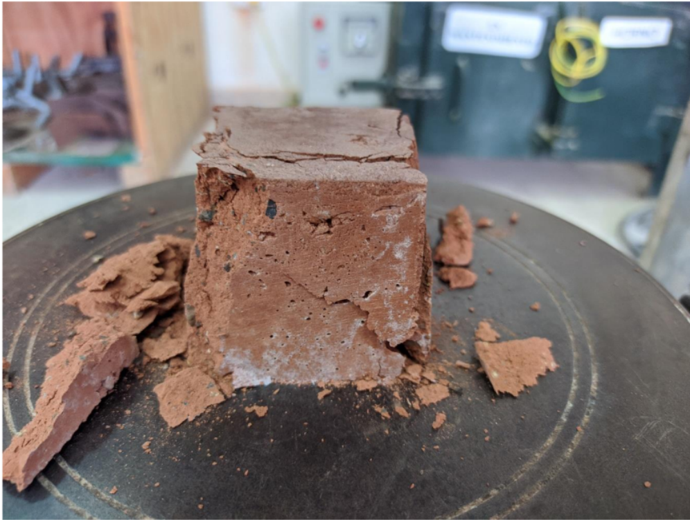
Falla de mortero por ensayo de compresión
