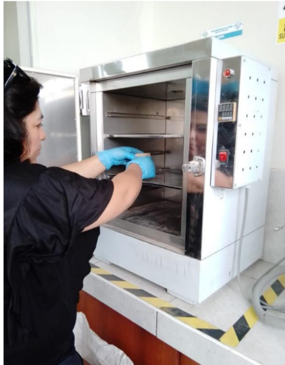
Colocación de las probetas de pastas y morteros en el horno
