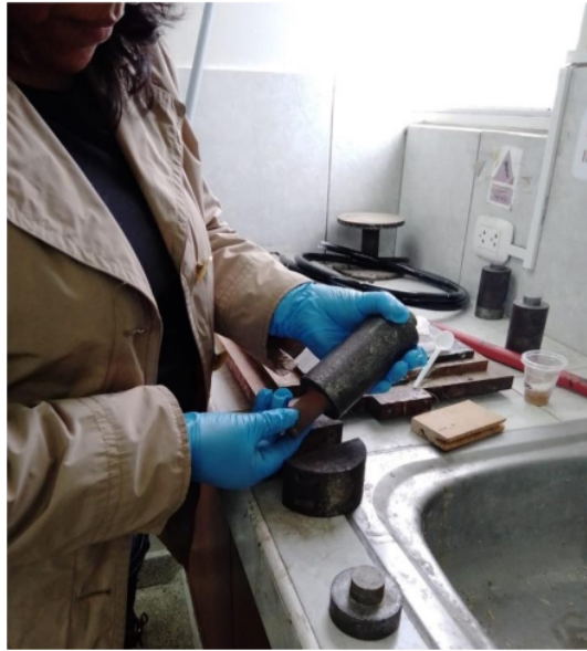
Medición de las dimensiones de las probetas de pastas con vernier
