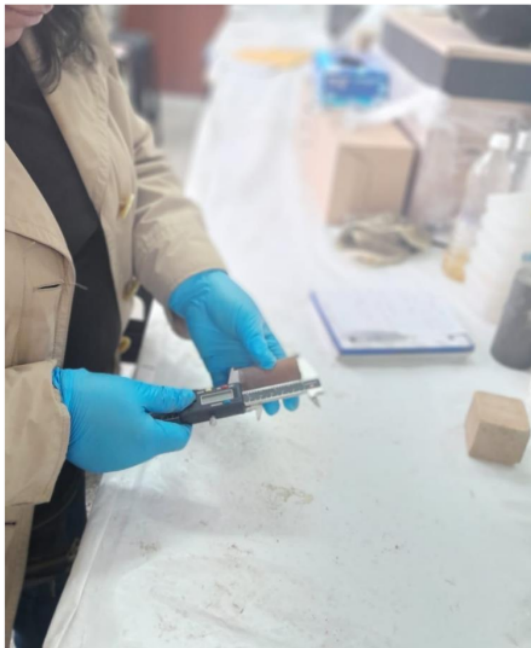
Medición de las dimensiones de las probetas de pastas con vernier
