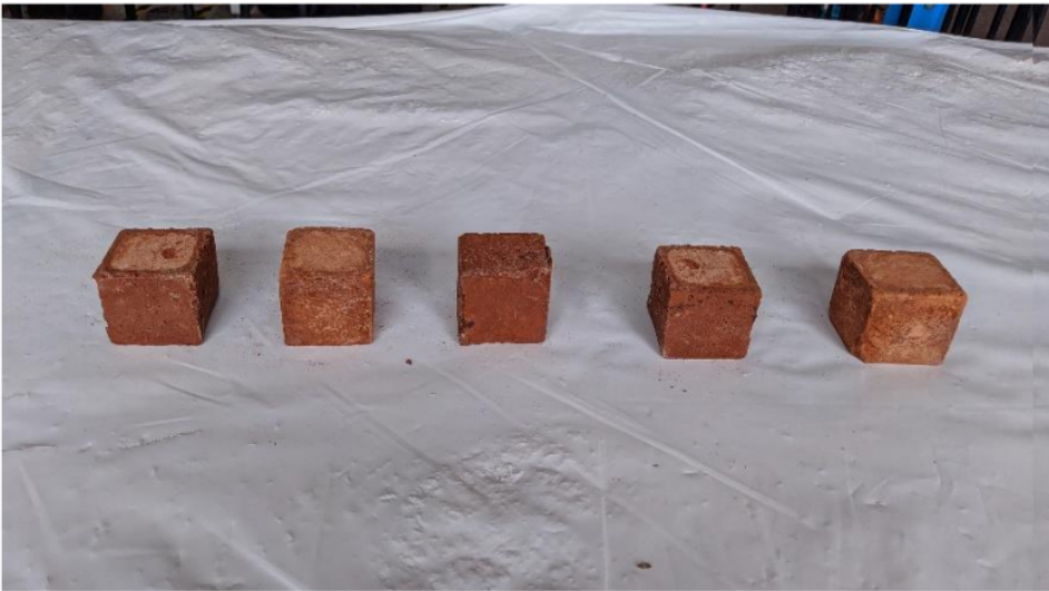
Morteros de grupo experimental con \text{Na}_2\text{SiO}_3 10.0 M
