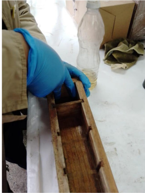
Colocación de aceite en el molde de morteros
