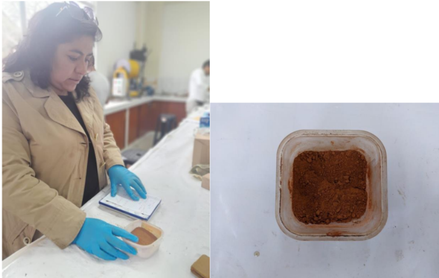
Geopolimerización con activador alcalino de solución de \text{Na}_2\text{SiO}_3
