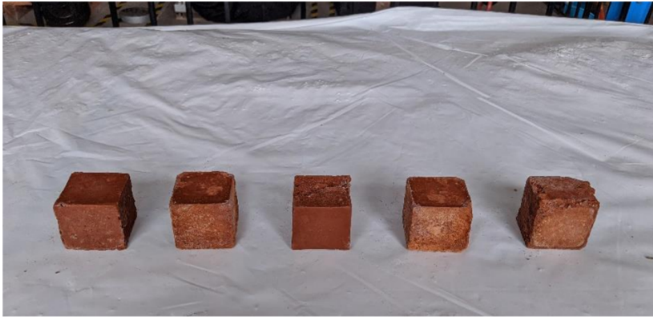
Morteros de grupo experimental con \text{Na}_2\text{SiO}_3 12.5M
