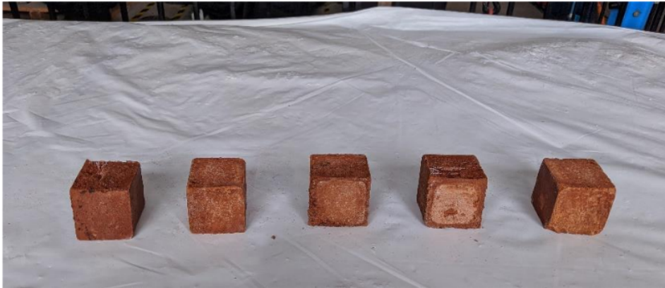
Morteros de grupo experimental con \text{Na}_2\text{SiO}_3 7.5M
