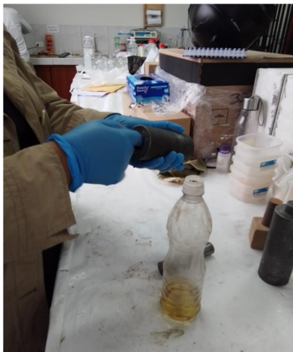
Colocación de aceite en el molde de pastas
