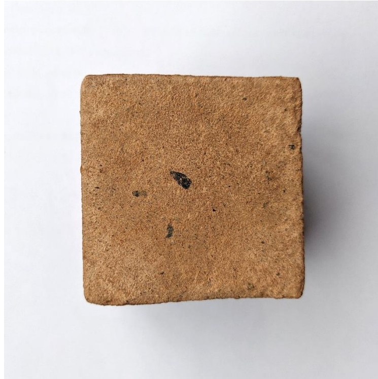
Mortero obtenido por geopolimerización a partir de escombros bajo la influencia de la concentración de KOH
