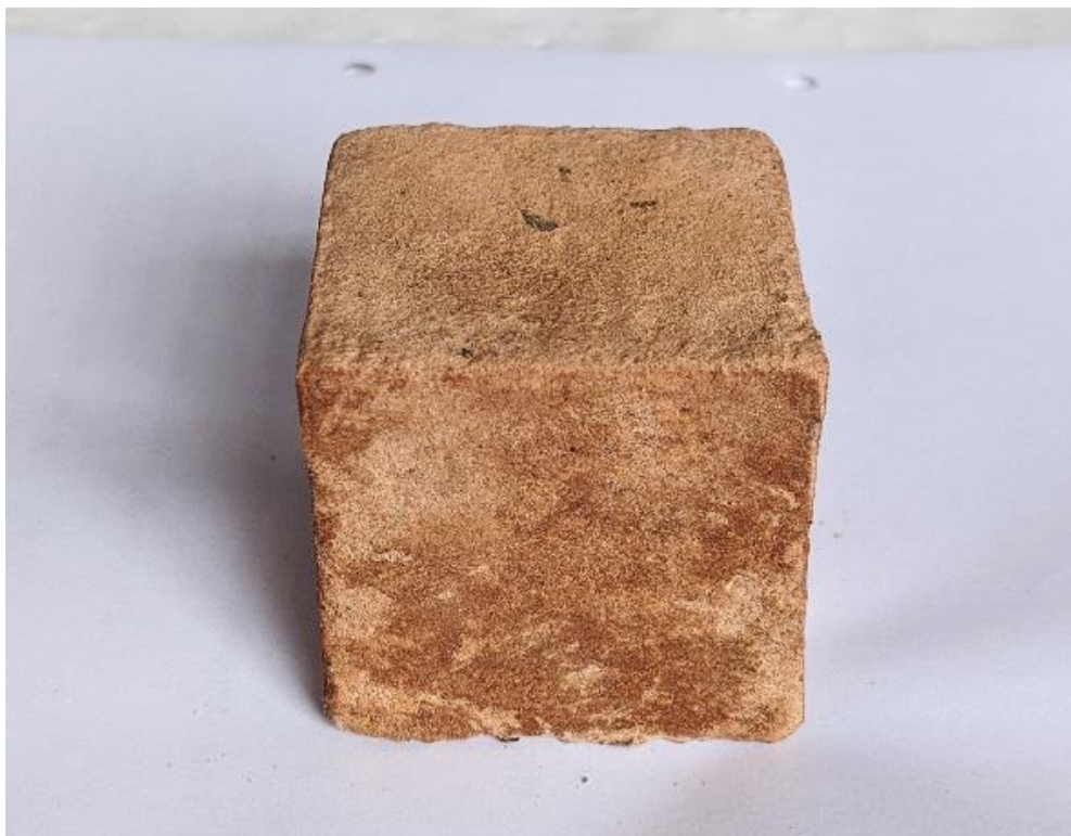
Mortero obtenido por geopolimerización a partir de escombros bajo la influencia de la concentración de KOH
