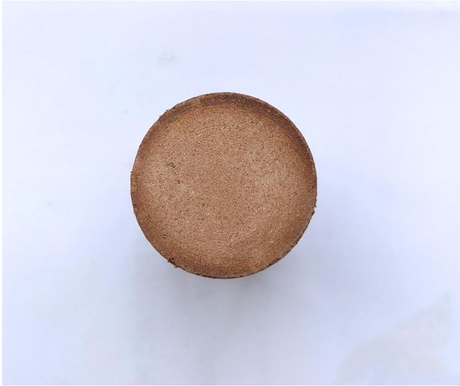
Pasta obtenida por geopolimerización a partir de escombros bajo la influencia de la concentración de KOH
