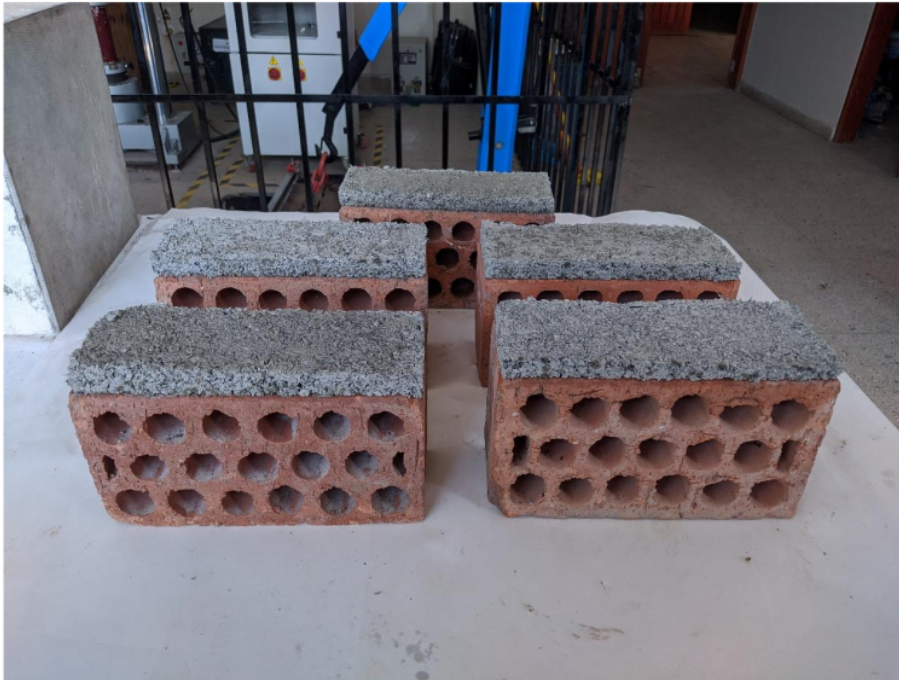
Morteros cubicos rectangulares con 20% de caucho reciclado
