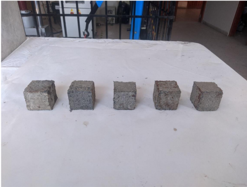
Morteros cubicos con 30% de caucho reciclado
