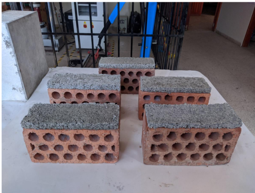
Morteros cubicos rectangulares con 10% de caucho reciclado
