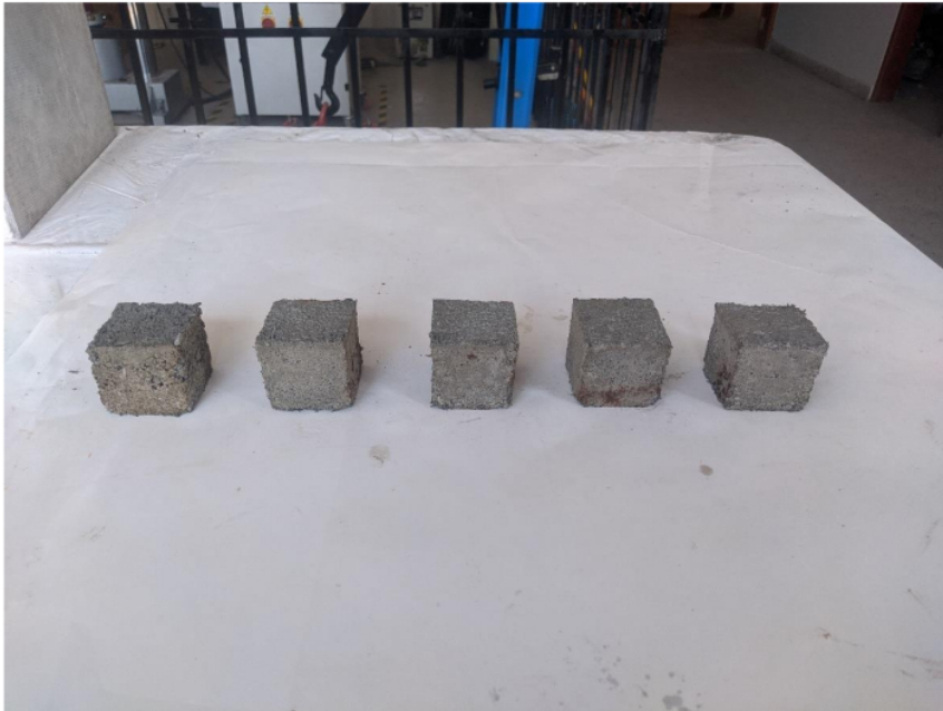
Morteros cubicos con 40% de caucho reciclado
