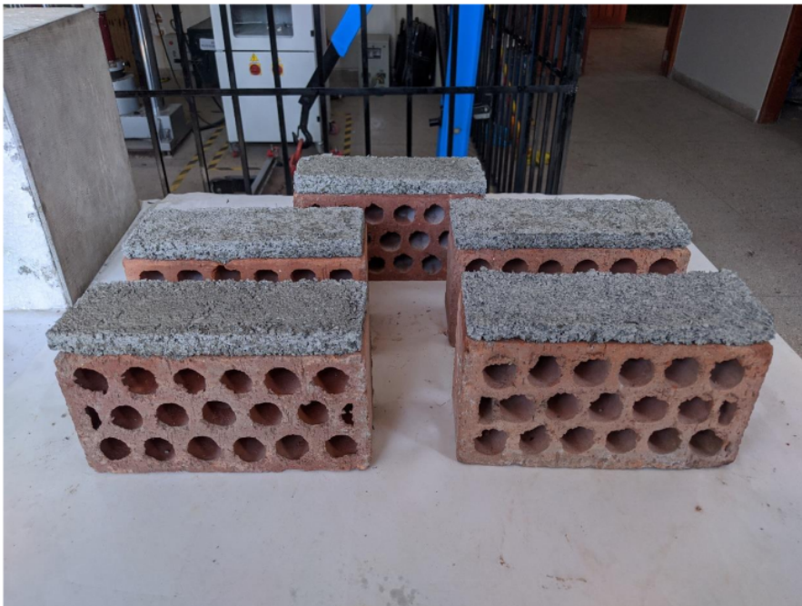
Morteros cubicos rectangulares con 40% de caucho reciclado
