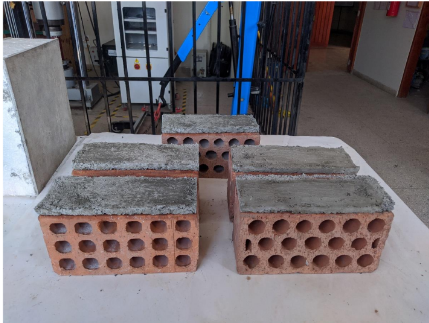
Morteros cubicos rectangulares con 10% de caucho reciclado
