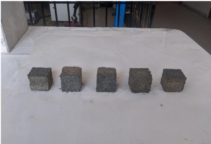
Morteros cubicos con 40% de caucho reciclado
