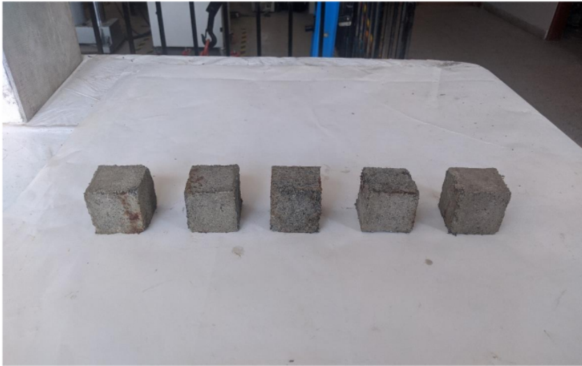
Morteros cubicos con 20% de caucho reciclado
