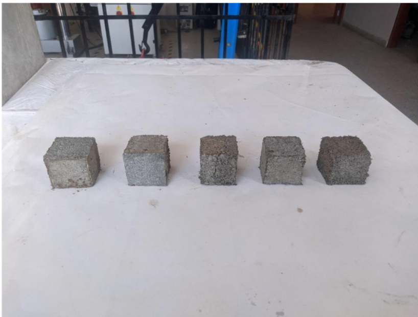
Morteros cubicos con 20% de caucho reciclado
