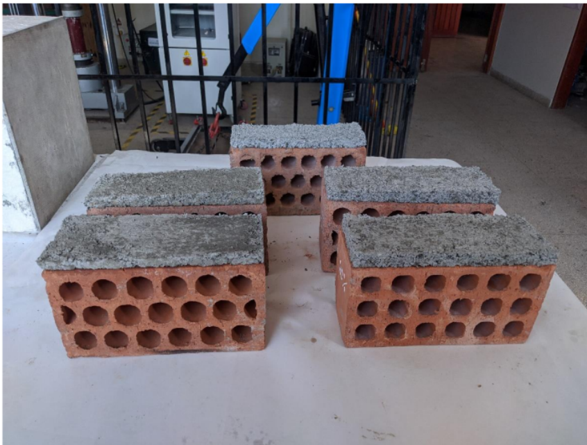
Morteros cubicos rectangulares con 30% de caucho reciclado
