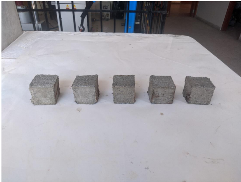
Morteros cubicos 2 con 10% de caucho reciclado
