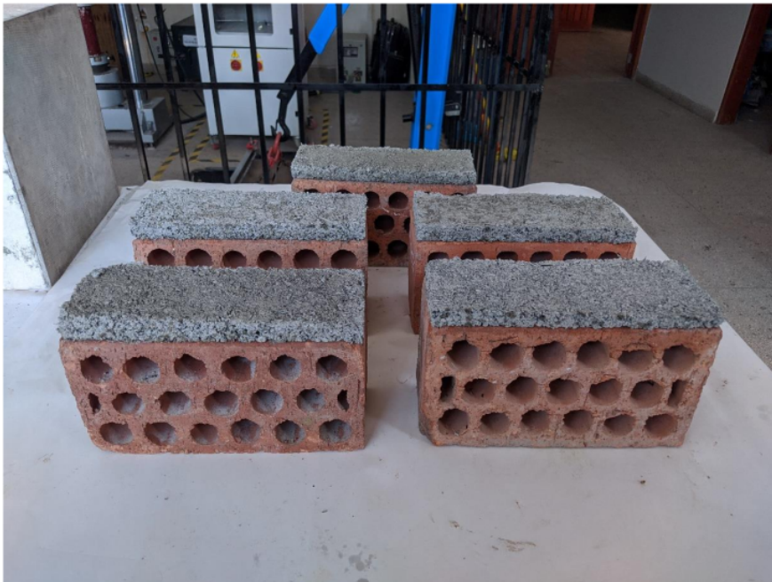
Morteros cubicos rectangulares con 20% de caucho reciclado
