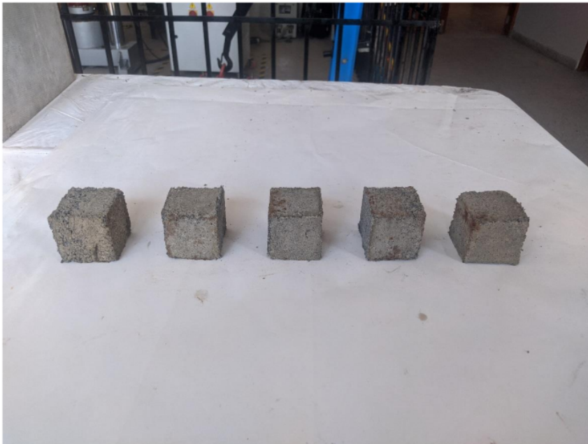
Morteros cubicos con 30% de caucho reciclado
