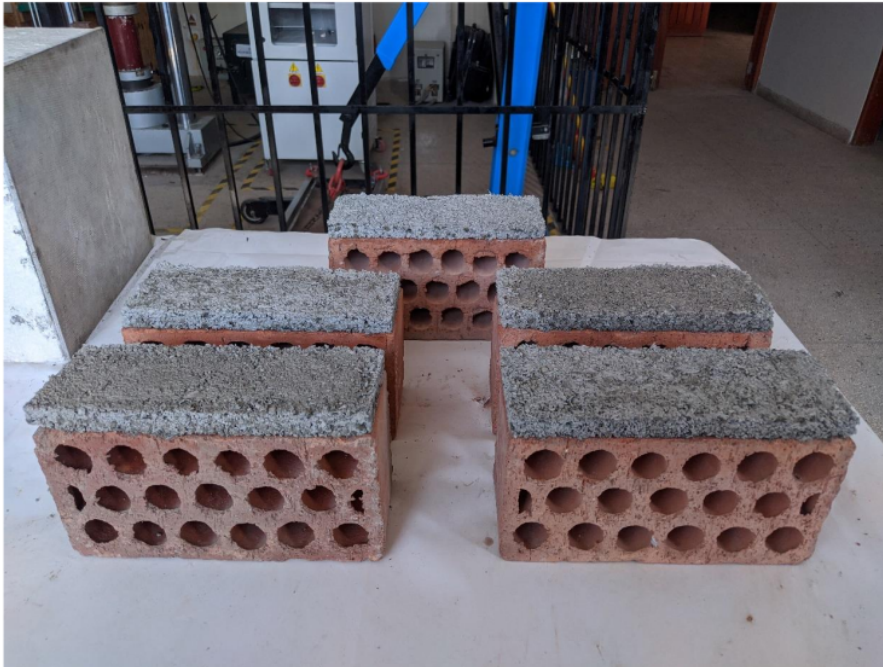
Morteros cubicos rectangulares con 40% de caucho reciclado
