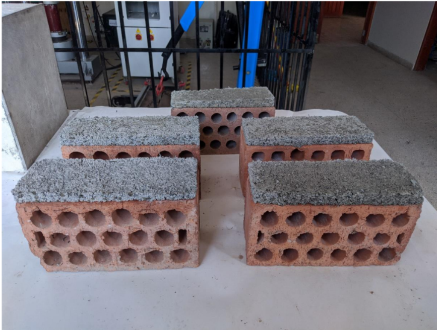
Morteros cubicos rectangulares con 30% de caucho reciclado
