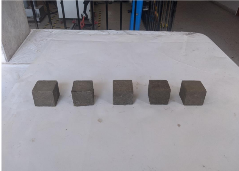
Morteros cubicos 2 con 10% de caucho reciclado
