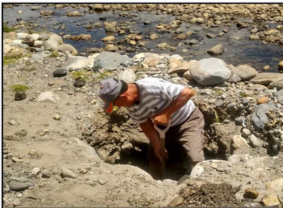
Realizando calicata N°1
