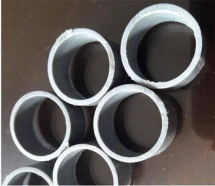
Se realizaron cortes de 1.5 cm a un tubo de PVC de 2.5 cm de diámetro para la obtención de anillos de PVC, que sirvieron como andamio para la confección de las probetas.
