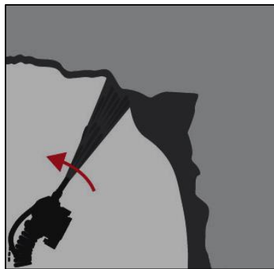
FIGURA N° 18. Sigüientes capas de proyección según parámetros de obra
