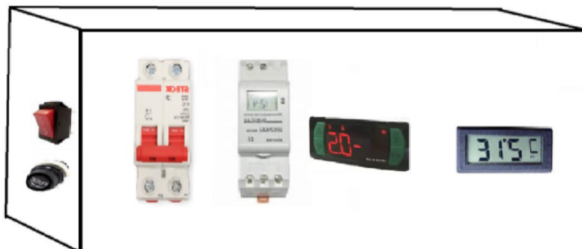
Figura N°20 Implementación de sistema de conectores y botones en caja de paso
