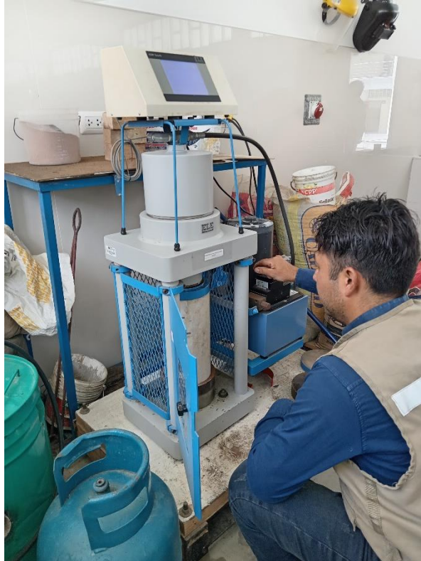
Rotura de probetas a compresión
