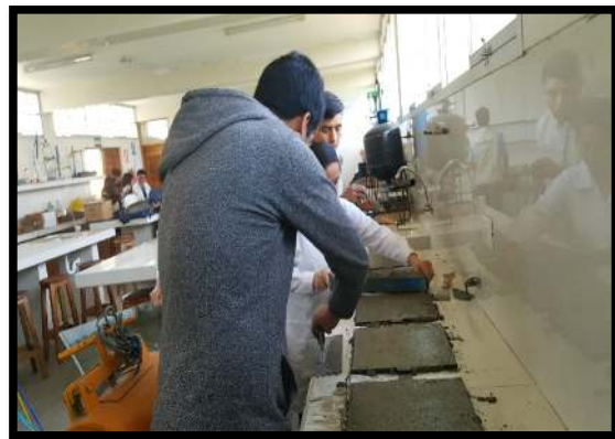
Vaciado de mezcla en paneles
