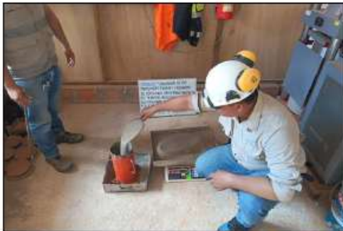
FOTO 17: SE OBSERVA AL TESISTA INICIANDO CON EL ENSAYO DE PESO UNITARIO
