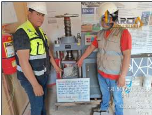
FOTO 01: SE OBSERVA LA FALLA DEL ADOQUÍN DESPUÉS DEL ENSAYO DE RESISTENCIA A LA COMPRESIÓN
