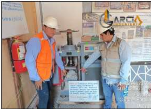
FOTO 13: SE OBSERVA LA FALLA DEL ADOQUÍN DESPUÉS DEL ENSAYO DE RESISTENCIA A LA COMPRESIÓN
