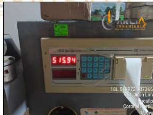
FOTO 12: SE OBSERVA EL RESULTADO DE LA FALLA DEL ADOQUÍN
