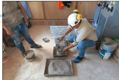
FOTO 05: PESO DE LA MUESTRAS PARA EL ENSAYO DE GRANULOMETRIA
