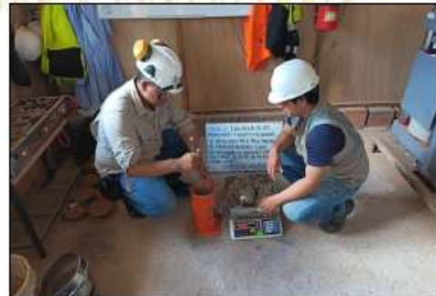
FOTO 14: SE OBSERVA AL TESIISTA REALIZANDO EL VARILLADO
