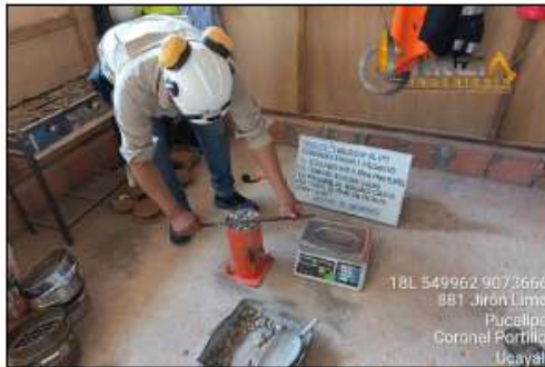
FOTO 15: SE OBSERVA EL ENRASADO DEL MOLDE
