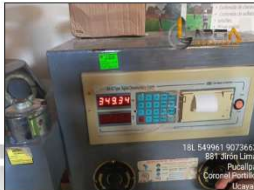
FOTO 02: SE OBSERVA EL RESULTADO DE LA FALLA DEL ADOQUÍN
