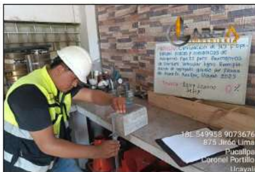
FOTO 05: MEDICION DE LOS ADOQUINES CON REGLA METALICA Y VERNIER
