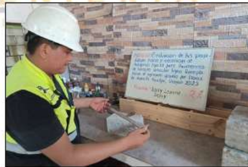
FOTO 04: MEDICIÓN DEL ANCHO DEL ADOQUIN CON VERNIER
