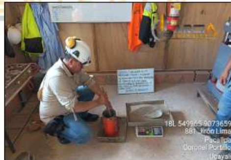
FOTO 18: SE OBSERVA AL TESISTA REALIZANDO EL VARILLADO
