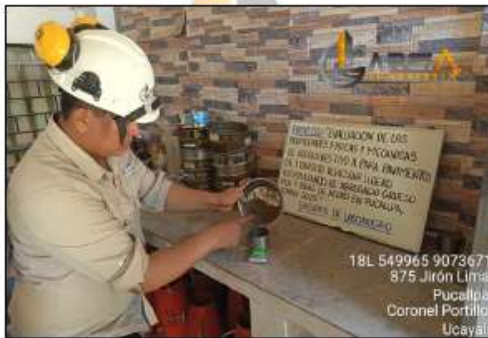
FOTO 09: PESO DE LA MUESTRA PARA DETERMINAR EL CONTENIDO DE HUMEDAD NATURAL
