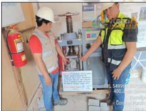
FOTO 03: SE OBSERVA LA FALLA DEL ADOQUÍN DESPUÉS DEL ENSAYO DE RESISTENCIA A LA COMPRESION
