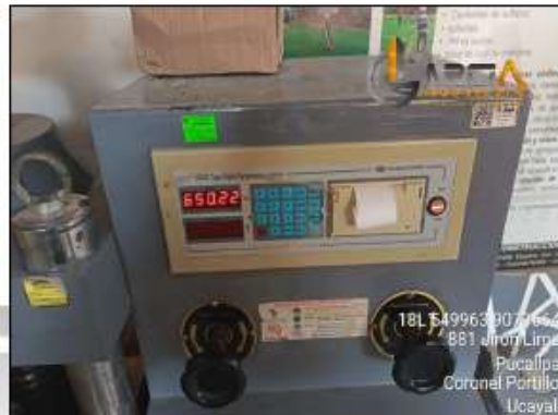
FOTO 14: SE OBSERVA EL RESULTADO DE LA FALLA DEL ADOQUÍN
