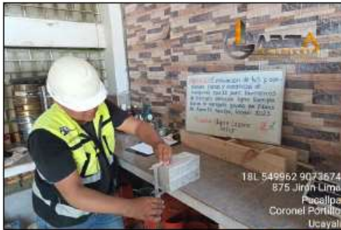
FOTO 03: MEDICIÓN DE LA LONGITUD DEL ADOQUIN CON VERNIER
