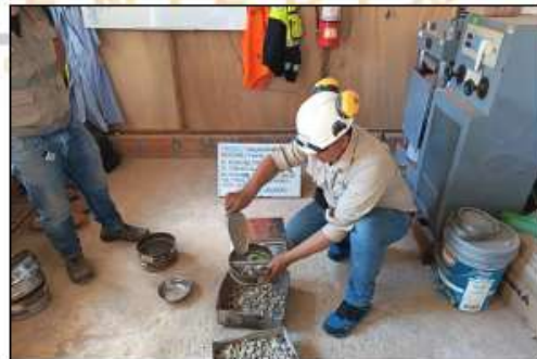
FOTO 01: PESO DE MUESTRAS PARA EL ENSAYO DE GRANULOMETRIA
