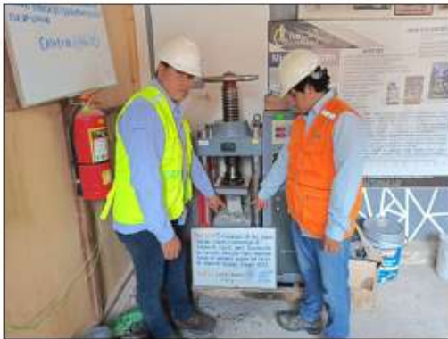
FOTO 09: SE OBSERVA LA FALLA DEL ADOQUÍN DESPUÉS DEL ENSAYO DE RESISTENCIA A LA COMPRESIÓN
