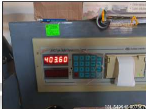
FOTO 06: SE OBSERVA EL RESULTADO DE LA FALLA DEL ADOQUÍN
