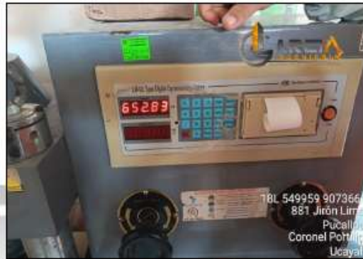
FOTO 14: SE OBSERVA EL RESULTADO DE LA FALLA DEL ADOQUÍN
