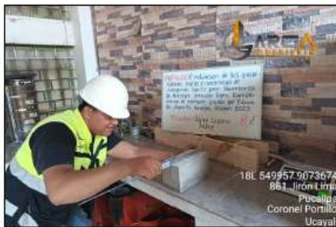
FOTO 01: MEDICIÓN DE LA LONGITUD DEL ADOQUIN CON VERNIER
