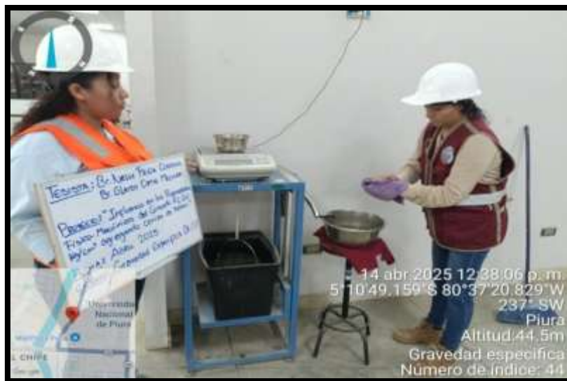
Secado parcial de la muestra SSS
