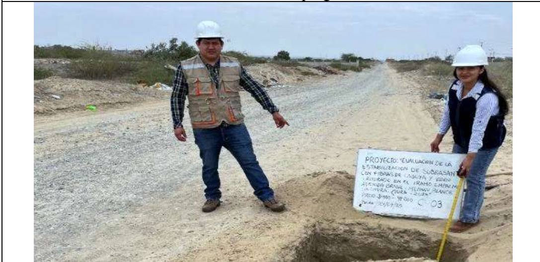
FOTO 10: Se extrae las muestras de la C-03, progresiva 3+000–4+000, en presencia de un técnico de laboratorio.
