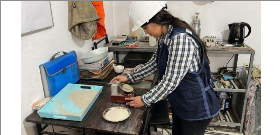
FOTO 21: Utilización de la Copa de Casagrande para crear la hendidura en las muestras.
