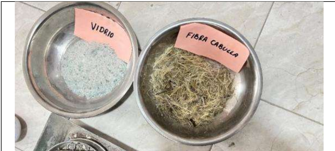
FOTO 26: Preparación de muestras experimentales con los diferentes porcentajes propuestos, 4%C+8%VT, 6%C+10%VT, 8%C+12%VT.
