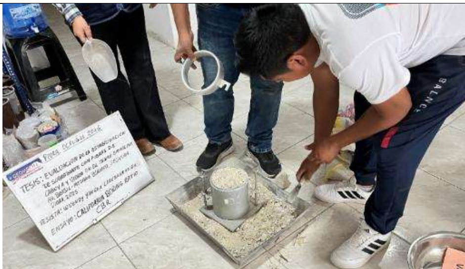
FOTO 28: Preparación del molde cilindro, para ensayo de CBR de una muestra con adición.
