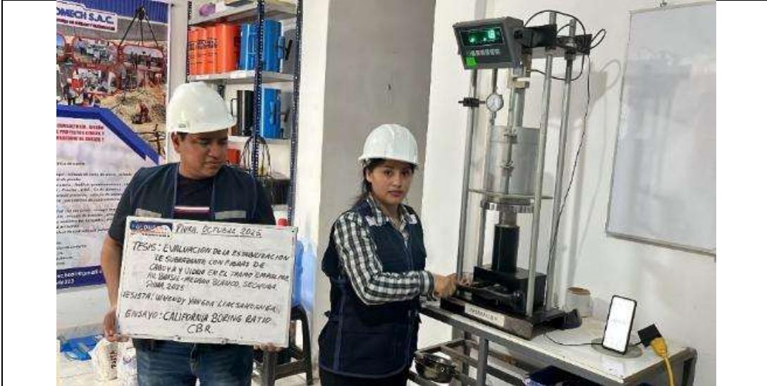
FOTO 25: Ensayo de CBR, previamente las muestras ya han sido preparadas para su correcto estudio.
