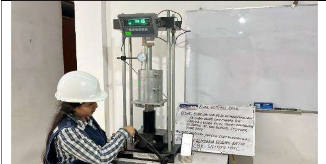
FOTO 29: ensayo de CBR a la Dosificación 8%C+12%VT.
