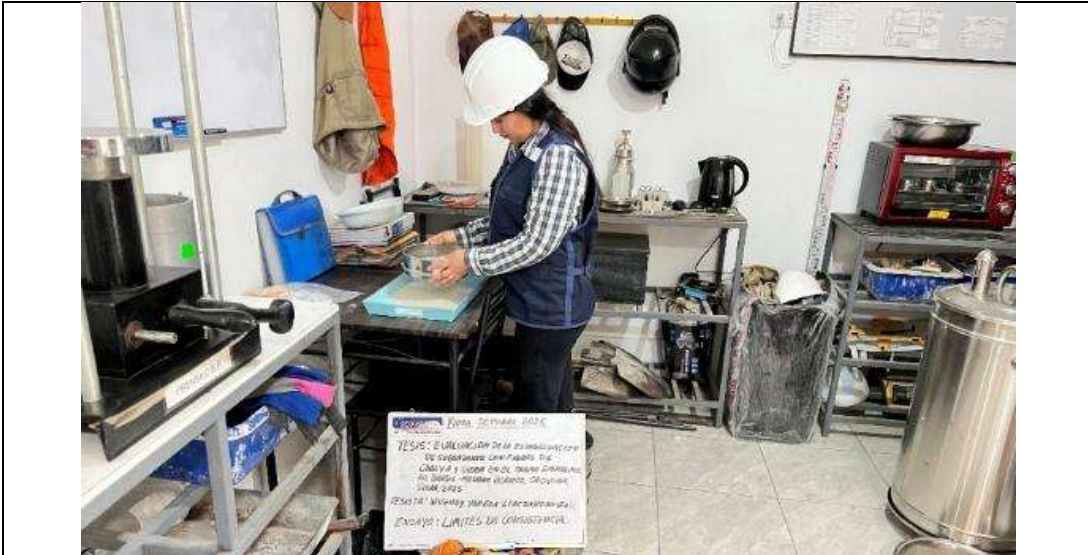
FOTO 20: tamizaje de finos para el ensayo límites de Atterberg, a las muestras del suelo natural.
