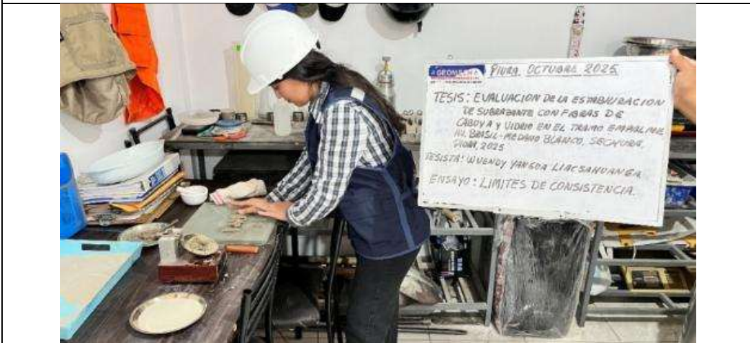
FOTO 22: Ensayos de Límites de Atterberg.
