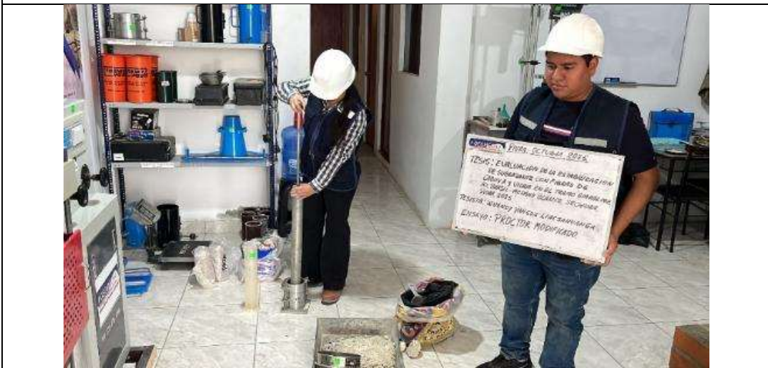
FOTO 24: A través de este ensayo a las muestras extraídas se determina, la densidad máxima seca y humedad óptima, para una compactación.
