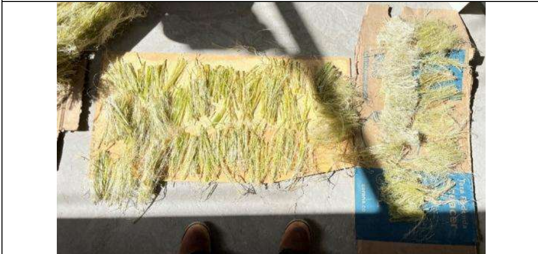
FOTO 15: Luego de extraer las fibras, se procede a colocarlas bajo el sol para su proceso de secado natural.
