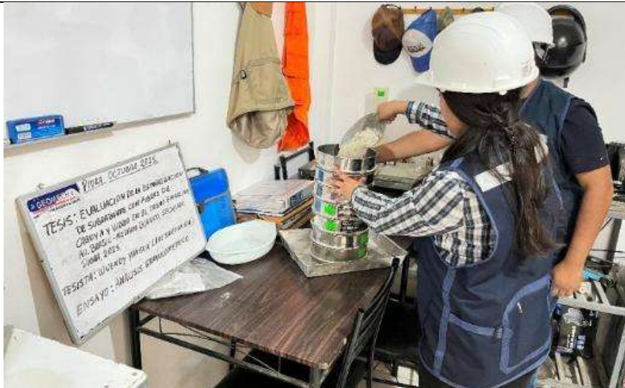
FOTO 19: Luego de trasladar los materiales a laboratorio se procede a realizar los ensayos granulométricos de cada calicata, del suelo natural.
