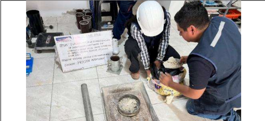
FOTO 23: preparación del material para el Proctor modificado.
