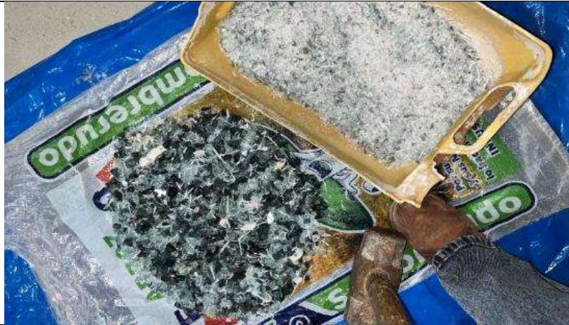
FOTO 17: Luego de recolectarse el vidrio reciclado, se procede a su trituración en partículas finas.
