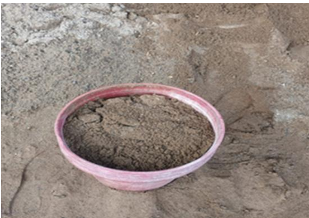
Foto 3 Toma de muestra del agregado fino
