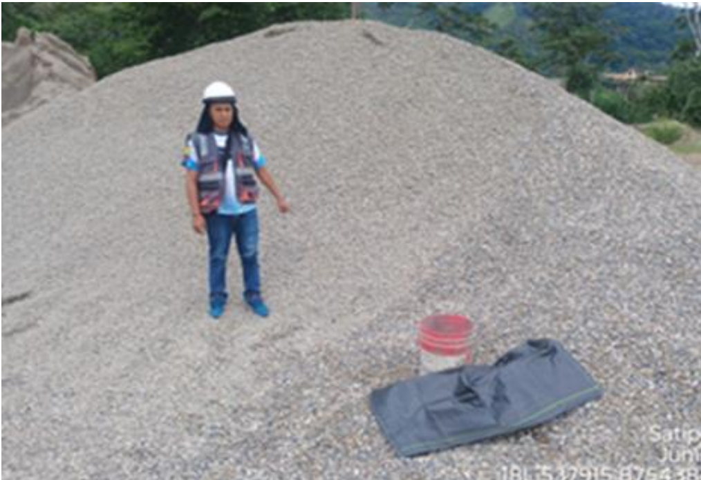
Foto 2 Ubicación de la toma de los Agregados. Agregado grueso.
