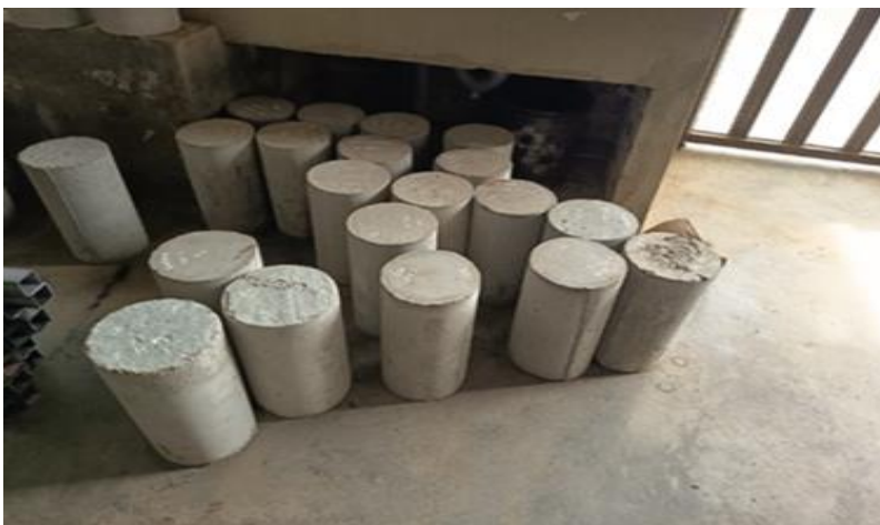
Foto 20 Cilindros de concretos a ensayar en diferentes edades.
