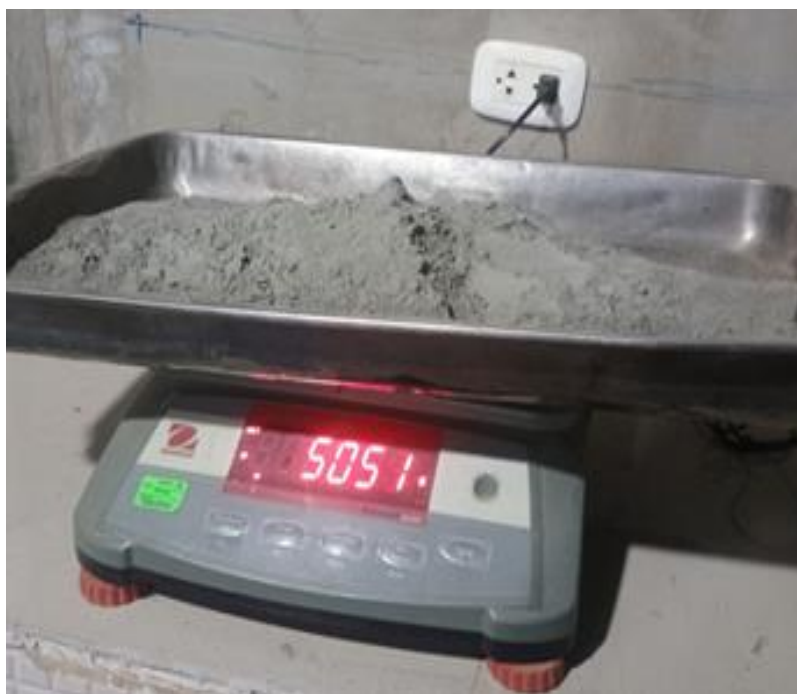
Foto 14 Peso del cemento a utilizar en el diseño de mezcla del concreto
