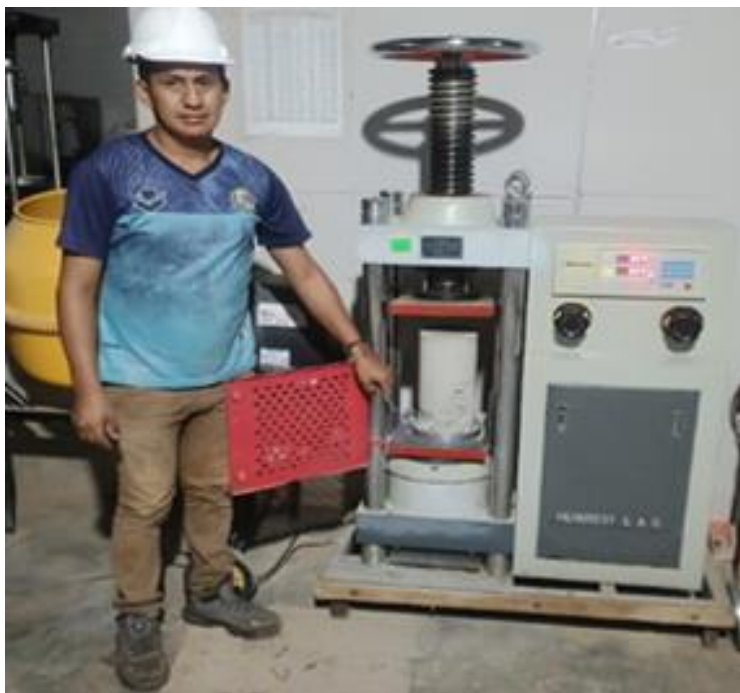
Foto 23. Ensayo a la compresión de las diferentes muestras de concreto.
