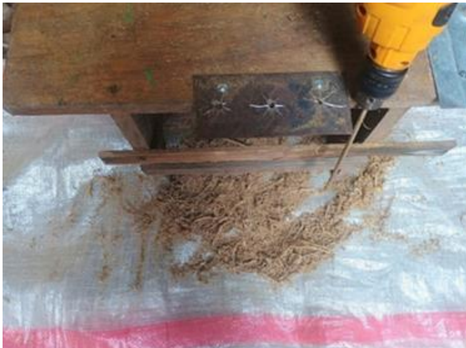
Foto 10 Proceso de obtención fibra de bambú a utilizar en este estudio.
