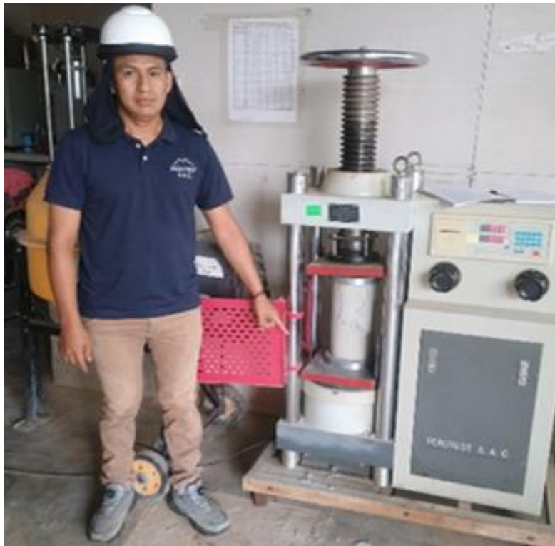
Foto 21 Ensayo a la compresión de las diferentes muestras de concreto.
