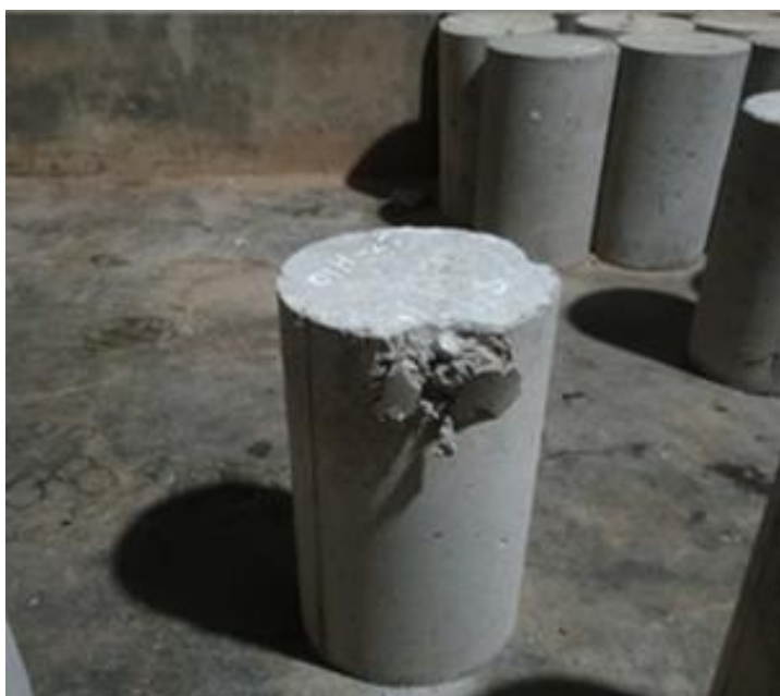
Foto 24 Muestra con porcentaje de fibra de bambú ensayada
