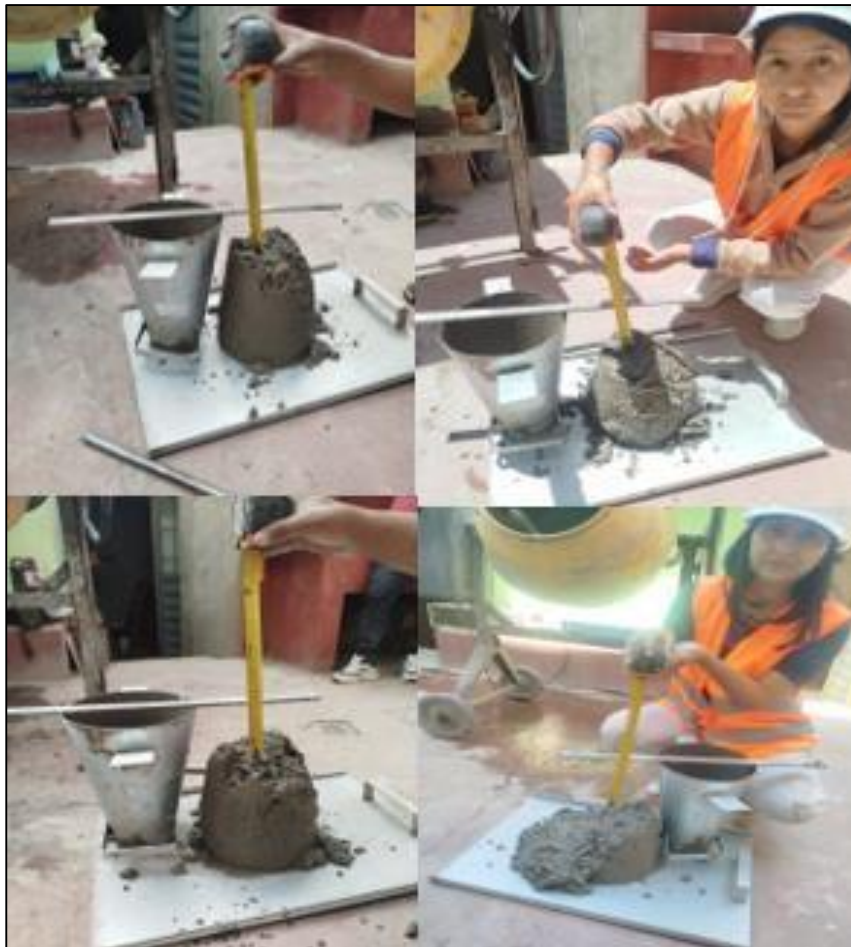
FOTO 14: Medición y registro del asentamiento
