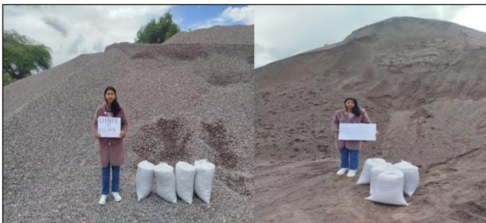
FOTO 08: Extracción de muestras de los agregados
