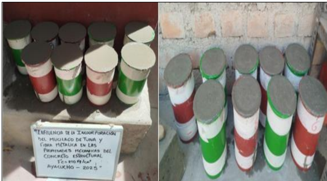
FOTO 16: Acabado de las superficies de los especímenes cilíndricos de concreto
