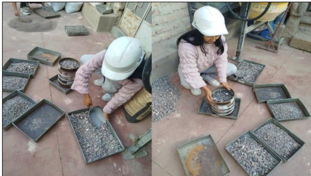
FOTO 10: Tamizado manual de los agregados
