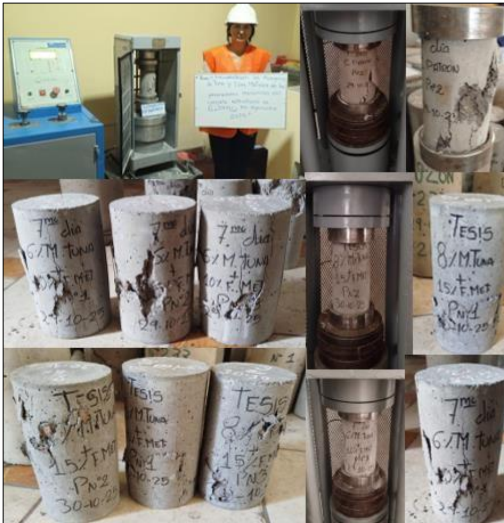
FOTO 20: Rotura de los especímenes cilíndricos
