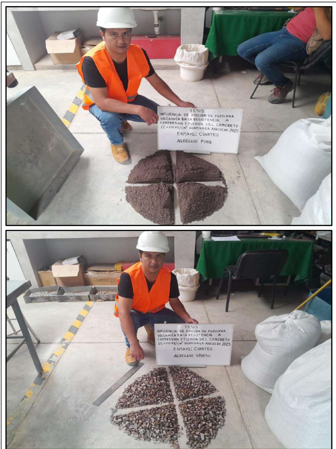
Figura 01-02. Se observa el ensayo de cuarteo de los agregados en el laboratorio, con fines de encontrar las propiedades para el diseño de mezcla.
