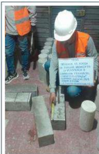
Concreto con 0% puzolana volcánica - concreto de control
