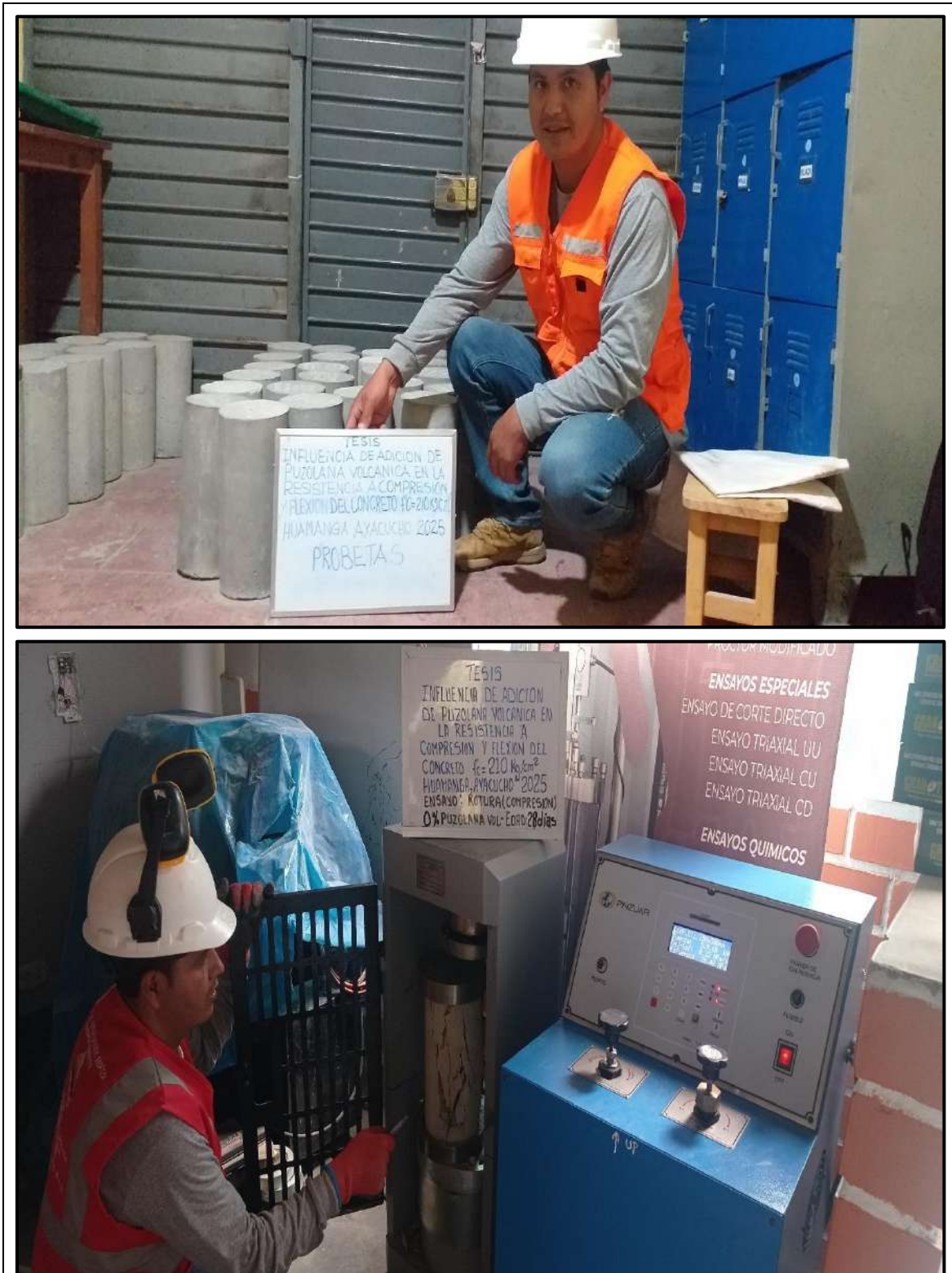
Figura 01-02. Se observa las probetas y el ensayo de resistencia a compresión del concreto de control a los 28 días.
