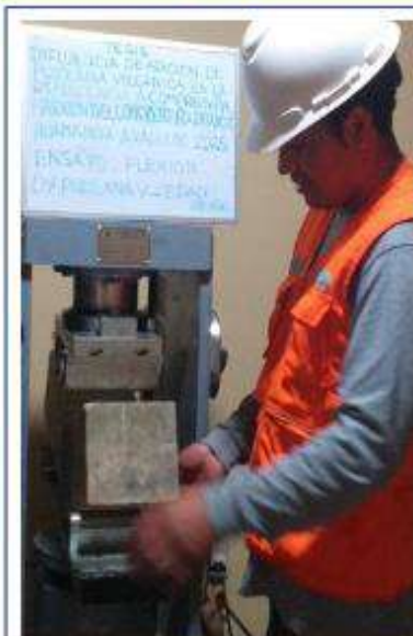
Concreto con 0% puzolana volcánica - concreto de control
