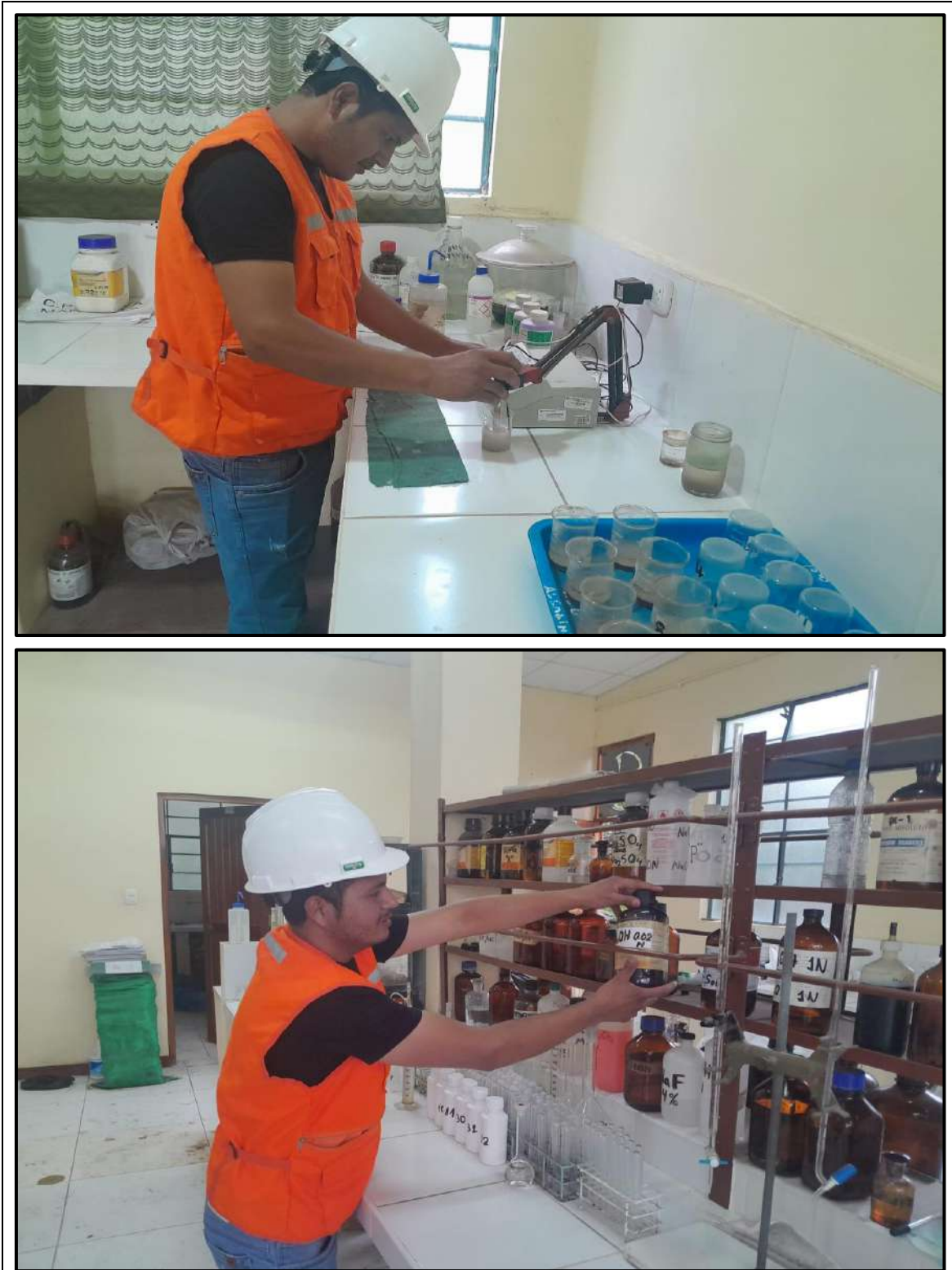
Figura 01-02. Se aprecia el ensayo químico de la puzolana volcánica en el laboratorio, ensayo de combinaciones de soluciones químicas.
