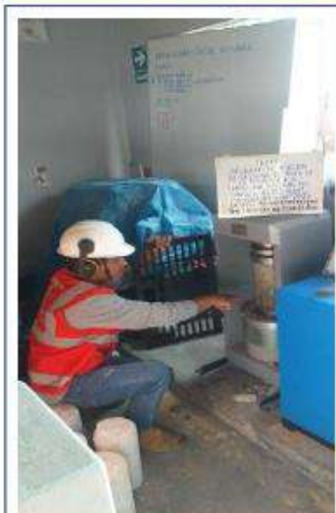
Concreto con 0% puzolana volcánica - concreto de control
