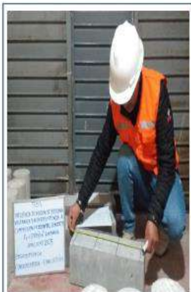
Concreto con 0% puzolana volcánica - concreto de control
