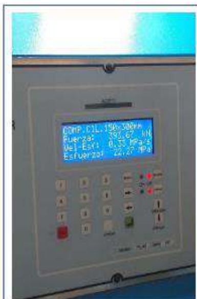
Concreto con 0% puzolana volcánica – concreto de control
