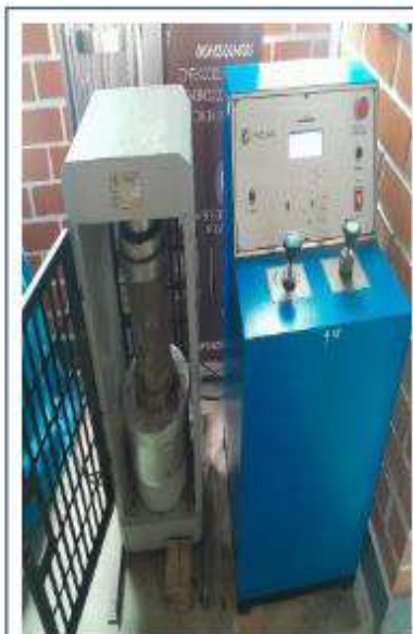
Concreto con 0% puzolana volcánica - concreto de control
