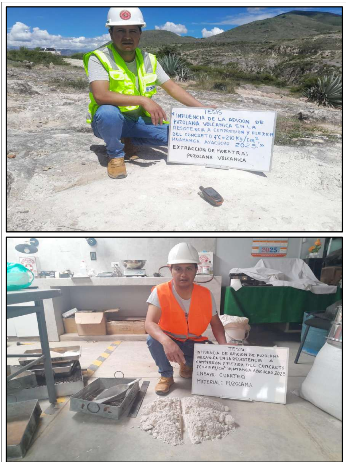
Figura 01-02. Se observa la cantera de la puzolana volcánica (Pacaycasa – Quiucho) y el ensayo de cuarteo.
