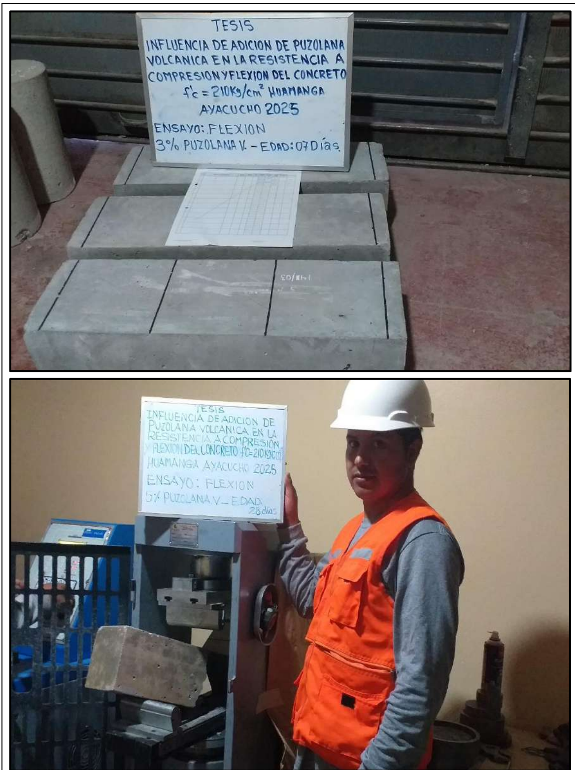
Figura 01-02. Se observa las vigas y el ensayo de resistencia a compresión del concreto con 5% de puzolana volcánica a los 28 días.
