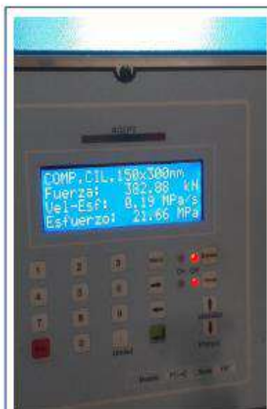
Concreto con 3% puzolana volcánica
