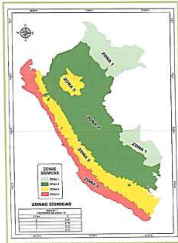
IMAGEN N° 01 - Zonificación sísmica Referencia RNE-E030.
