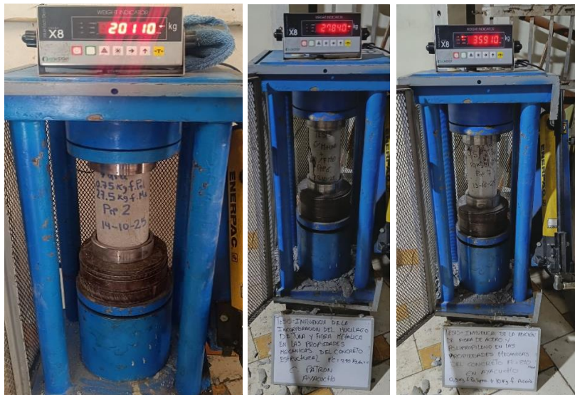
FOTO 15: Ensayo a compresión de la probeta de concreto patrón y adiciones
