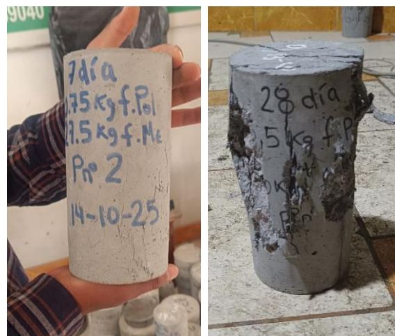
FOTO 16: Probeta resultante del ensayo a compresión
