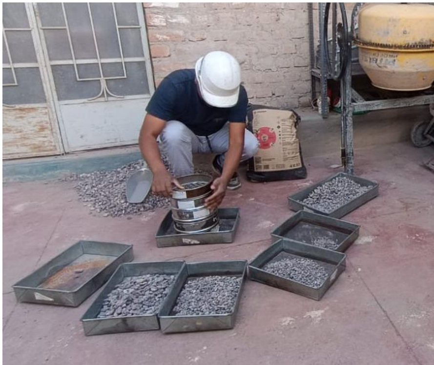
FOTO 04: Tamizado de la muestra de agregado grueso por el medio de mallas de diferente tamaño.
