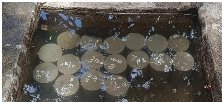
FOTO 13: Proceso de curado de las probetas cilíndricas
