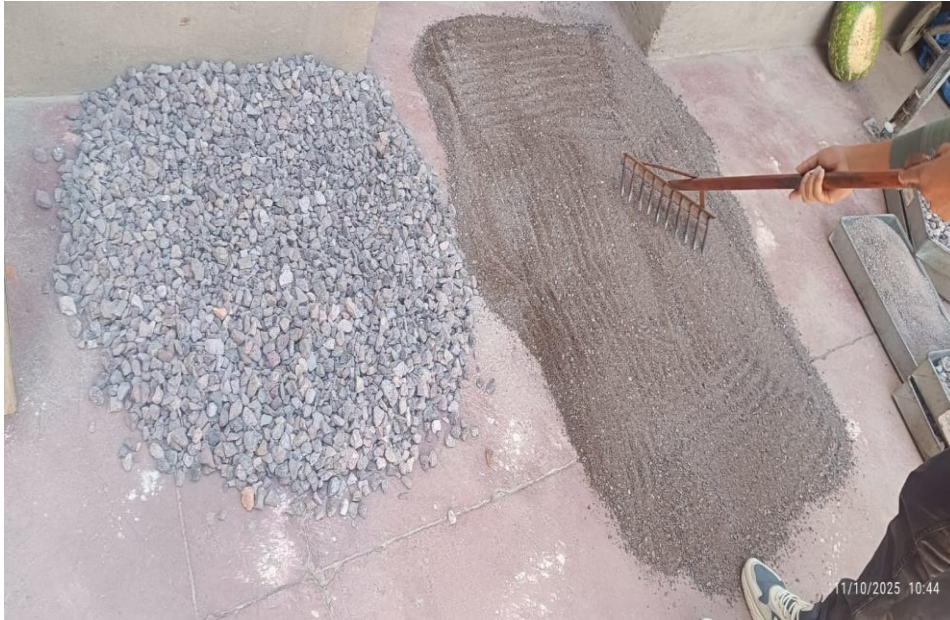
FOTO 03: Aplanado la pila cónica de agregado grueso y fino antes del cuarteo
