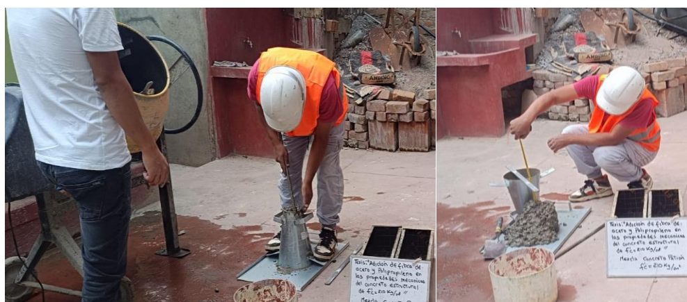
FOTO 10: Medición del asentamiento
