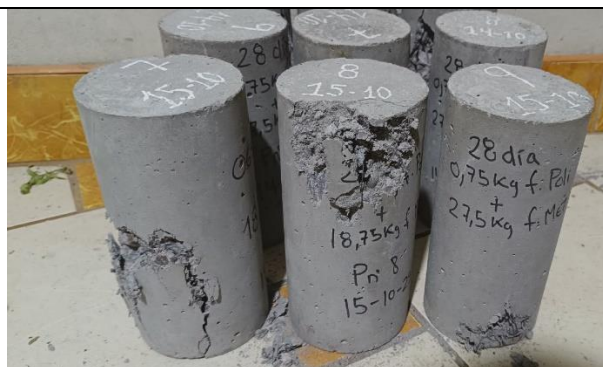
FOTO 17: Probeta resultante del ensayo a compresión
