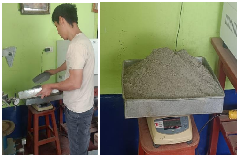
FOTO 07: Proceso de pesado de las proporciones halladas en el diseño del concreto y sus adiciones
