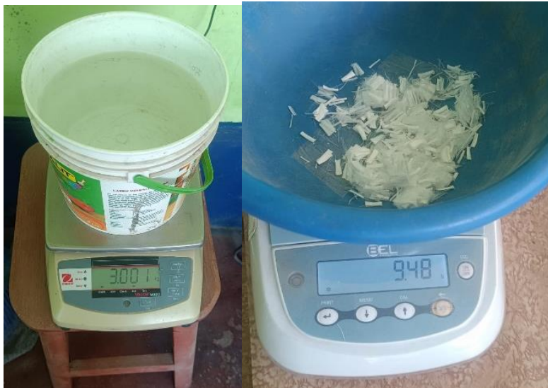
FOTO 06: Proceso de pesado de las proporciones halladas en el diseño del concreto y sus adiciones
