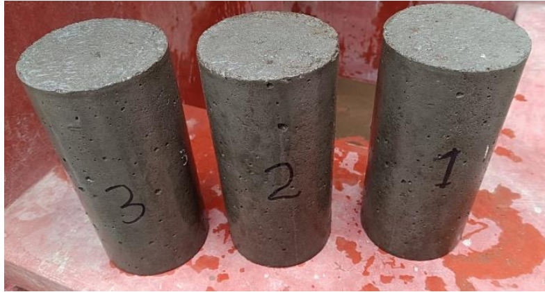
FOTO 14: Probetas retiradas de la poza de curado
