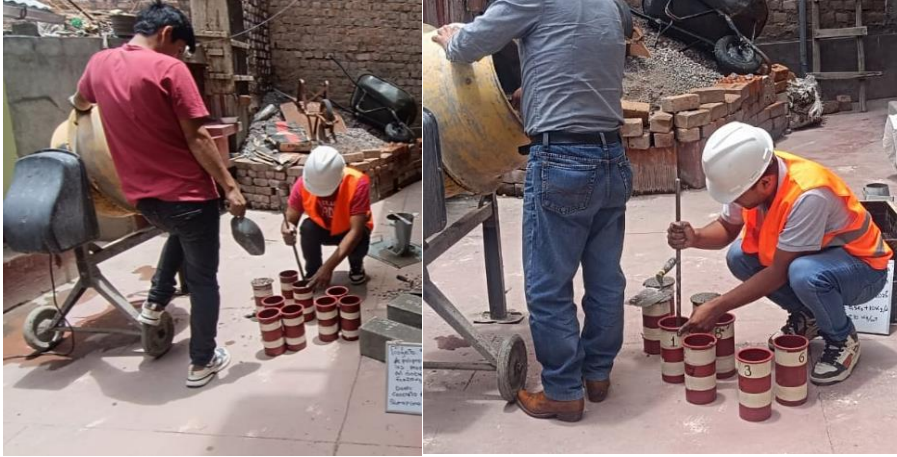
FOTO 11: Llenado de los moldes en capas y compactadas
