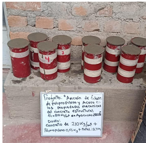
FOTO 12: Probetas identificadas y enrazadas
