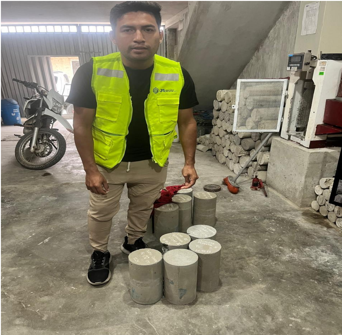
FOTO N°07: PROBETAS REALIZADAS DEL LABORATORIO QUALITY PARA EL CURADO
