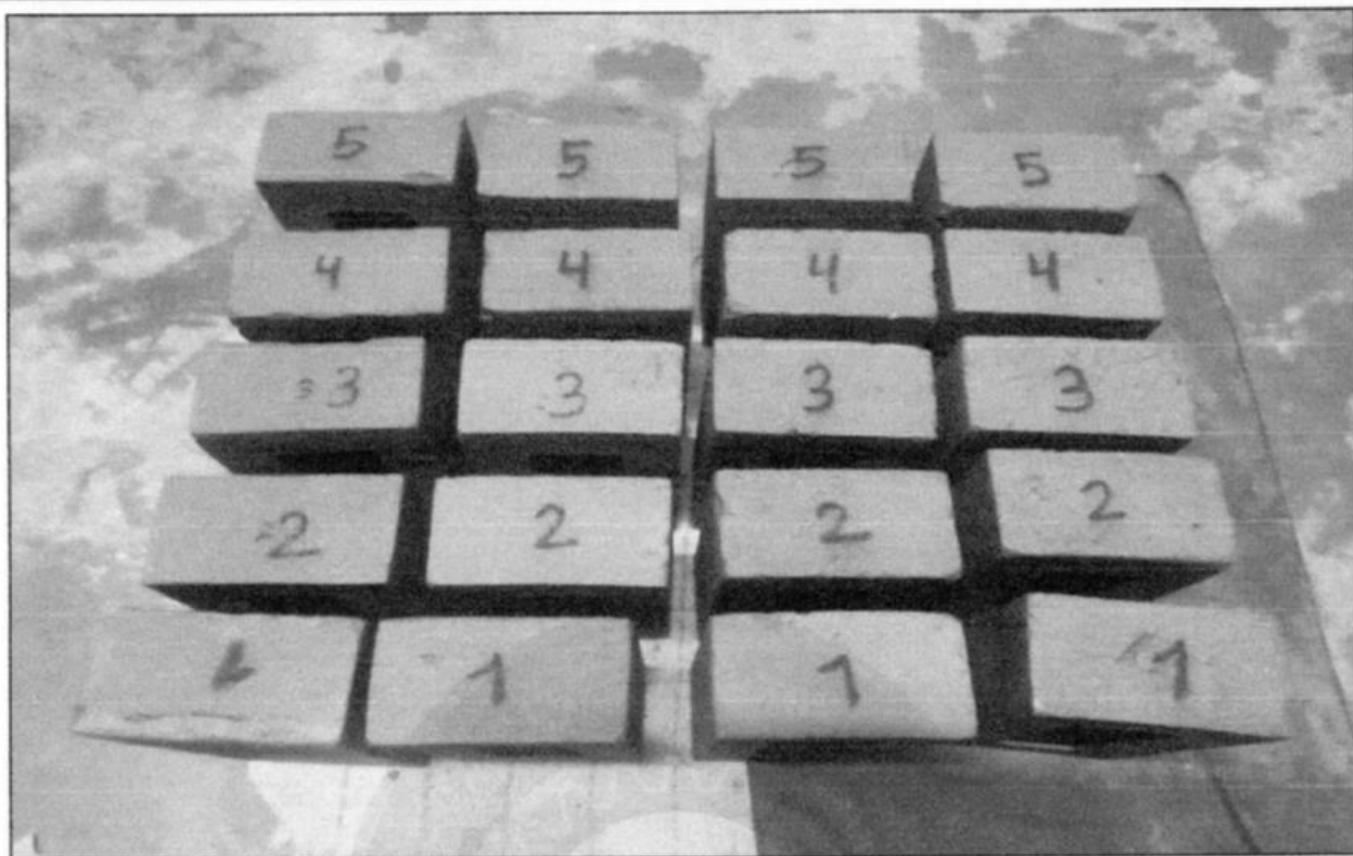
ENSAYO DE ABSORCION DE LOS LADRILLOS ARTESANALES PATRON Y CON ADICION DE FIBRA DE CASCARA DE COCO
