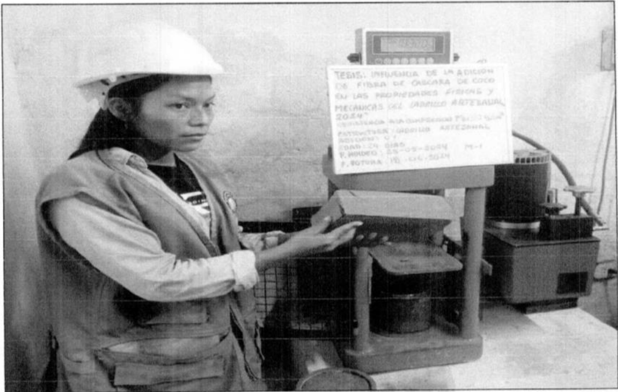
ROTURA DEL LADRILLO ARTESANAL PATRON M-1, UNIDAD DE ALBAÑILERIA, f^b = 50 \text{ Kg/cm}^2
