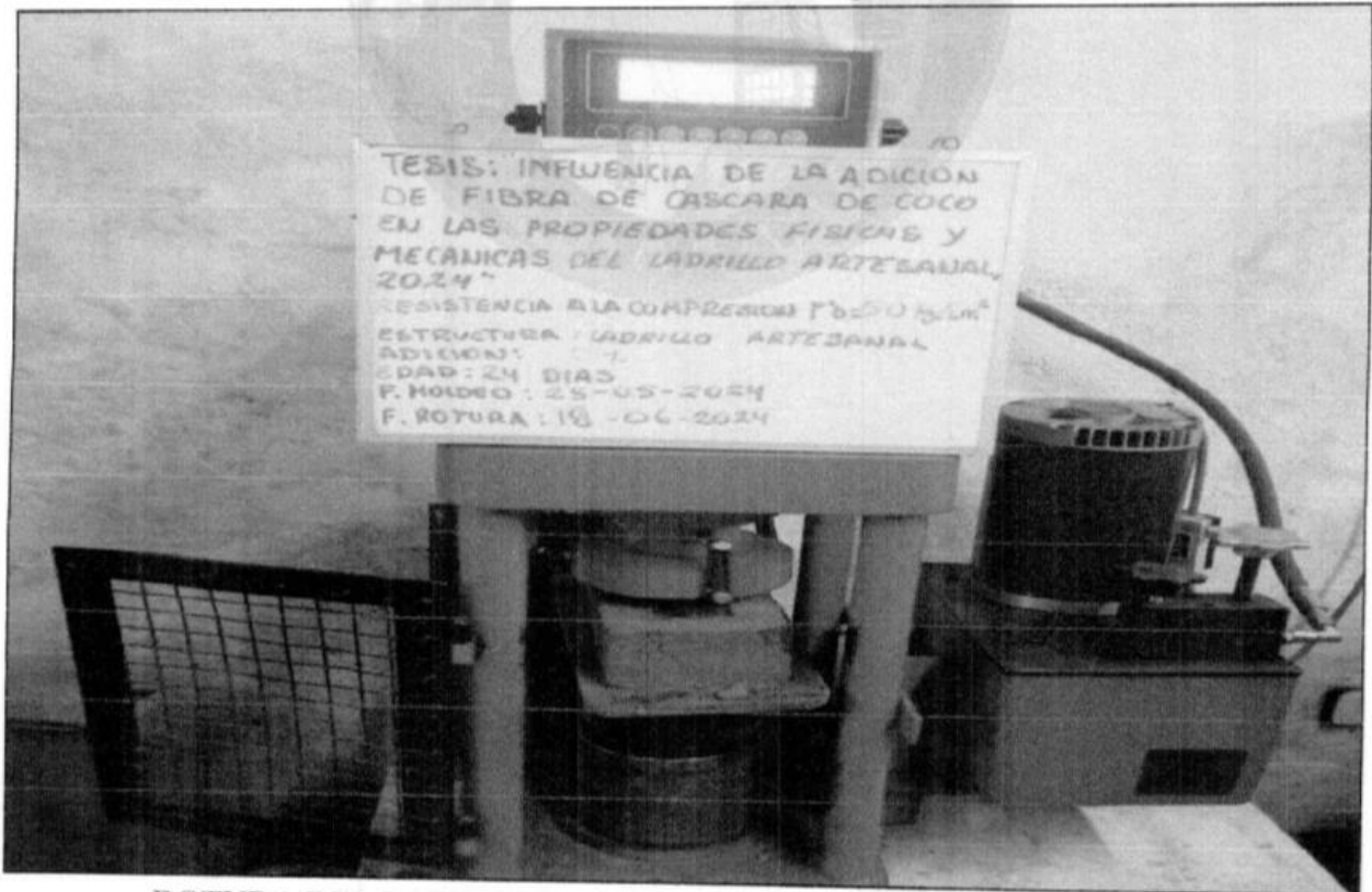
ROTURA DEL LADRILLO ARTESANAL PATRON M-2, UNIDAD DE ALBAÑILERIA, f^b = 50 \text{ Kg/cm}^2
