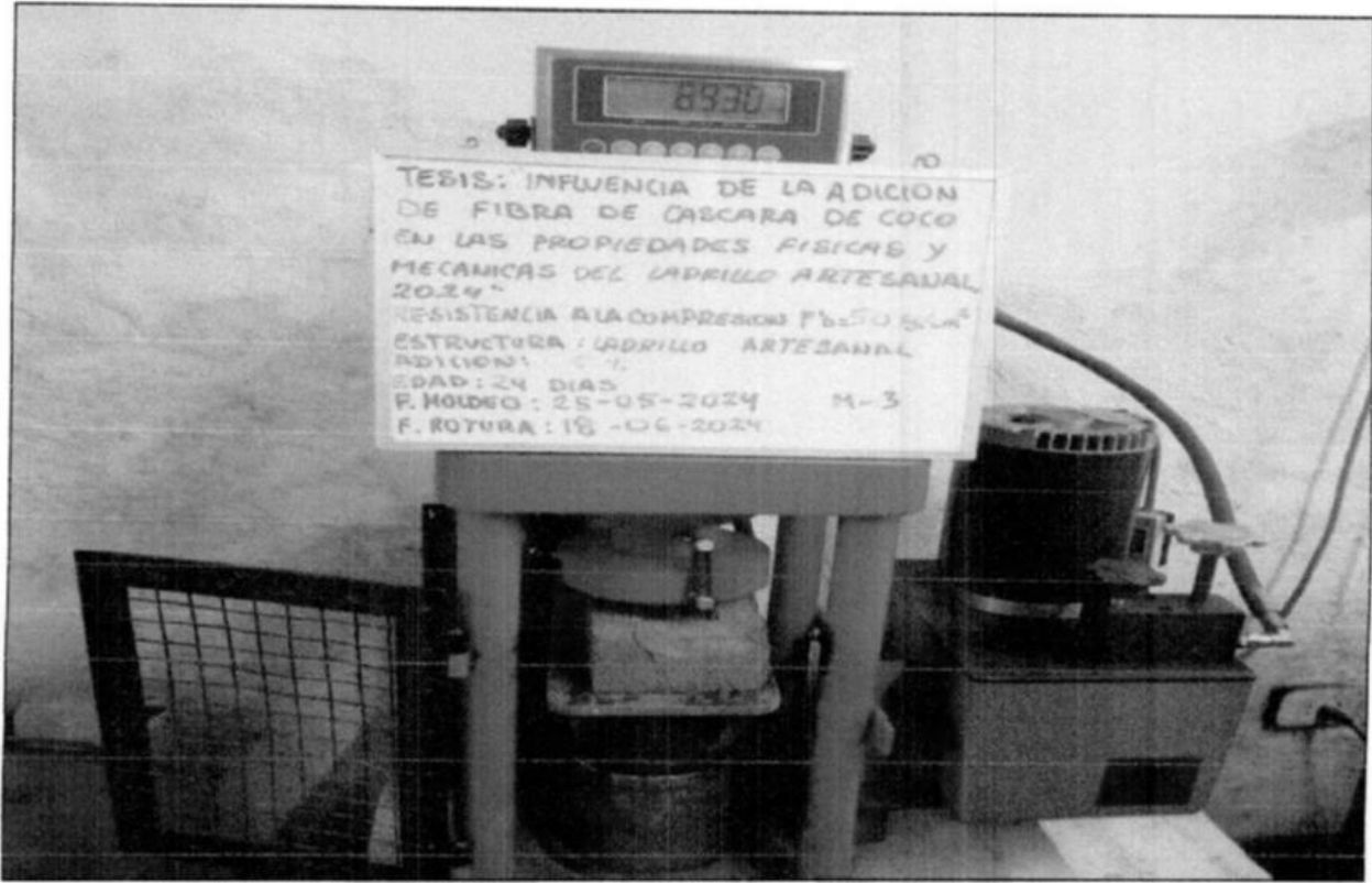
ROTURA DEL LADRILLO ARTESANAL PATRON M-3, UNIDAD DE ALBAÑILERIA, f'_{cb} = 50 \text{ Kg/cm}^2
