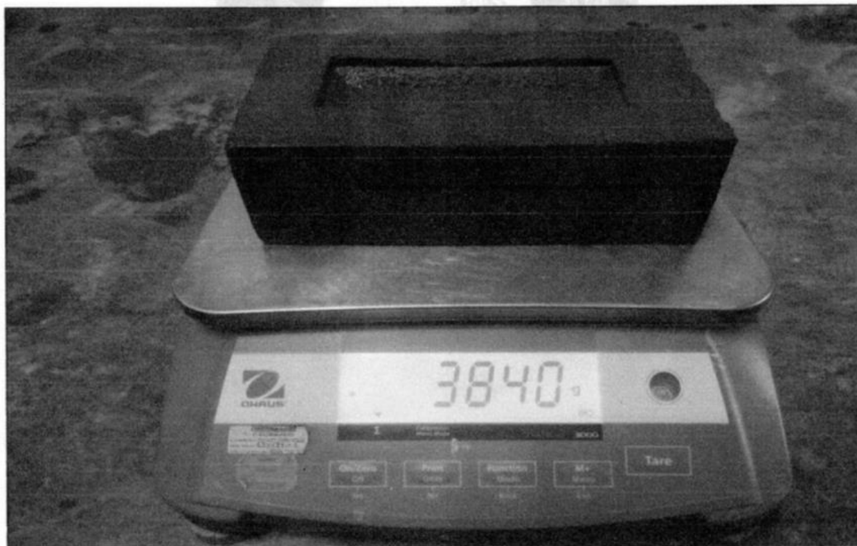
ENSAYO DE ABSORCION DEL LADRILLO ARTESANAL PATRÓN
