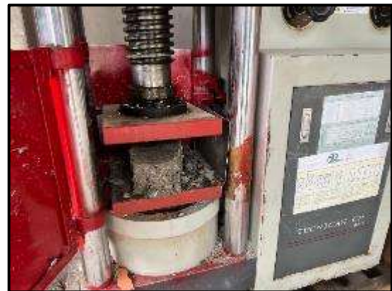
Resultado de rotura del ladrillo de concreto con adiciones de ceniza de semilla de aguaje
