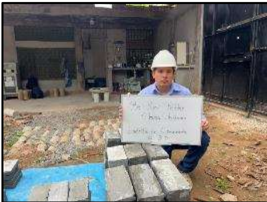
Ladrillos de concreto con 3% de adición
