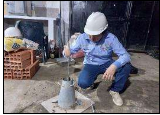
Compactado de mezcla en molde para SLUMP
