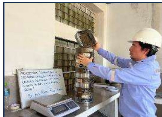
Llenado del agregado fino para su tamiz
