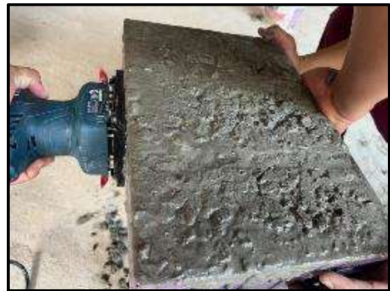
Vibrado de la mezcla en el molde
