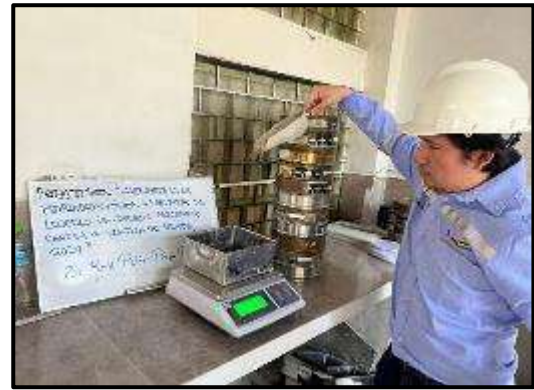
Pesado del agregado grueso para tamizado
