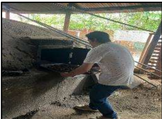
Proceso de calcinación de las semillas de aguaje en el horno
