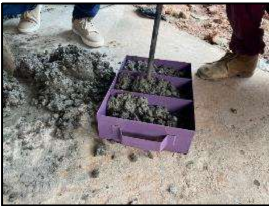
Compactado de la mezcla en el molde
