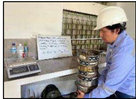
Tamizado del agregado grueso
