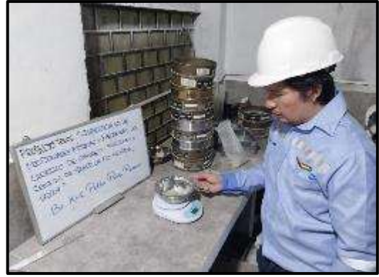
Pesado de ceniza de semilla de aguaje según dosificación
