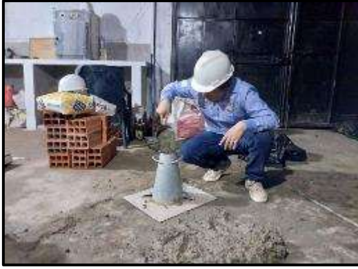
Llenado de mezcla en molde para SLUMP
