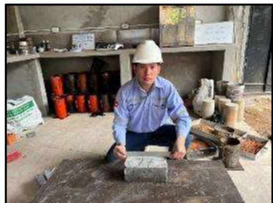
Medición del ladrillo de concreto con 7% de adición
