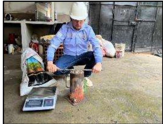
Enrasado de las 3 capas del agregado grueso
