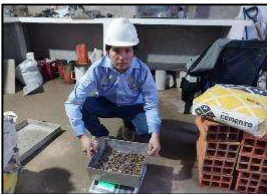
Pesado del agregado grueso según dosificación
