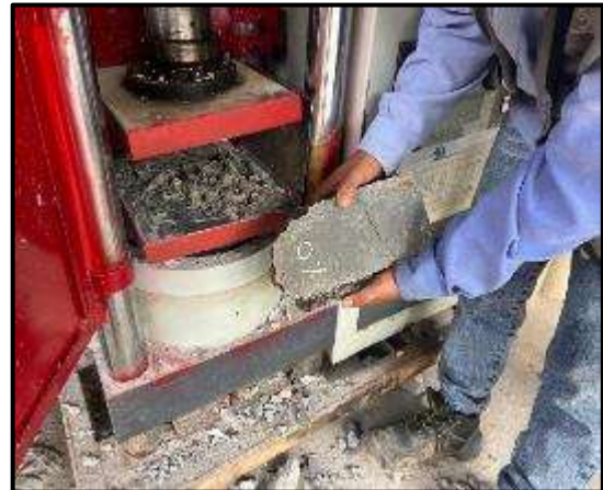
Resultado de rotura del ladrillo de concreto patrón
