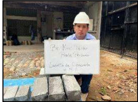
Ladrillos de concreto con 5% de adición
