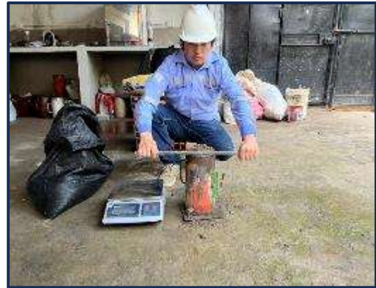
Enrasado de las 3 capas del agregado fino
