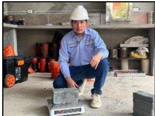
Pesado de ladrillo de concreto seco
