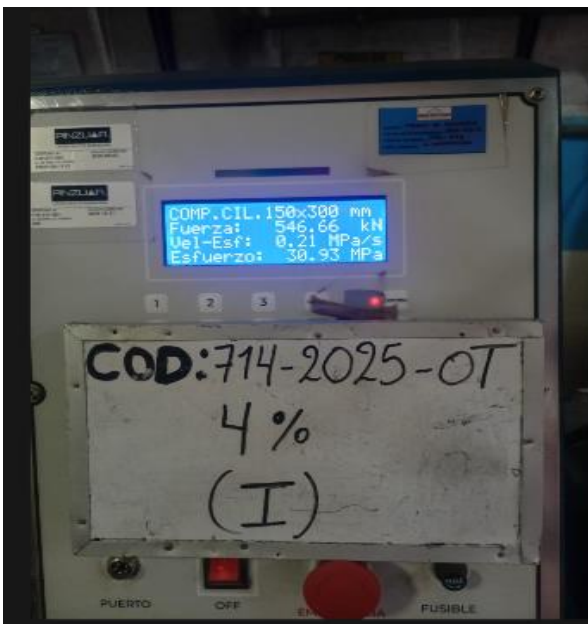
Fotografía 15: ensayo de compresión de concreto en probeta cilíndrica 4%-I
