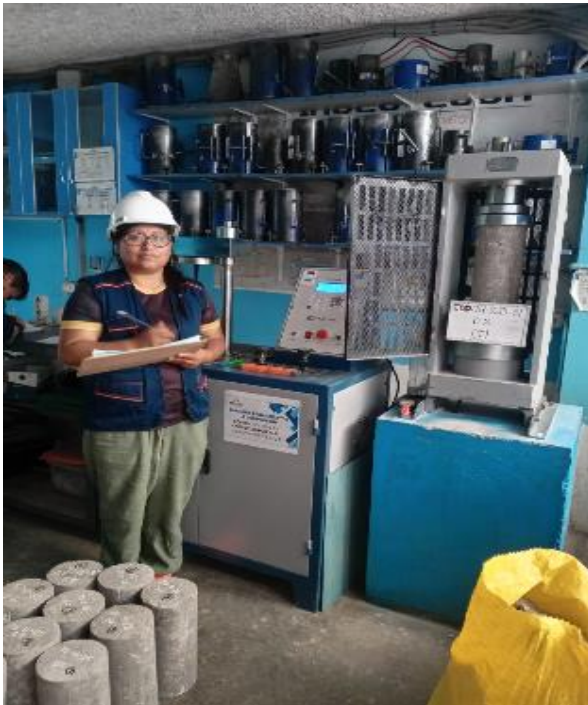
Fotografía 9: ensayo de compresión de concreto en probeta cilíndrica 0%-III
