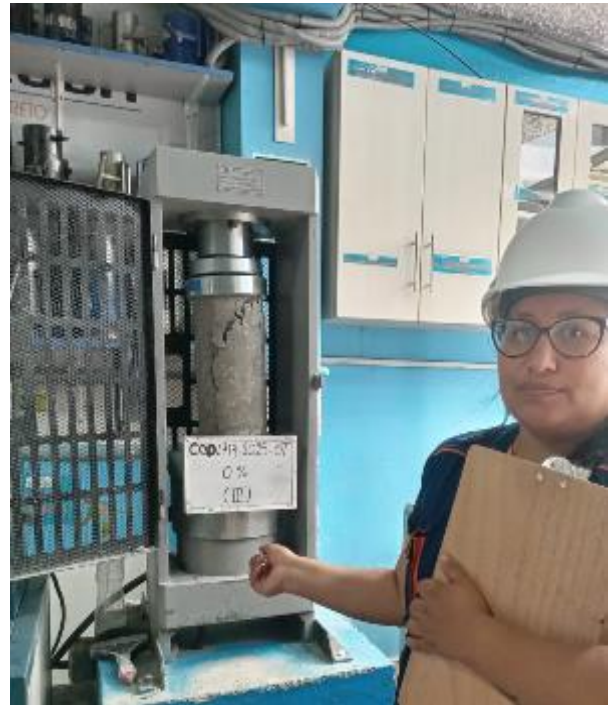
Fotografía 10: ensayo de compresión de concreto en probeta cilíndrica 0%-IV
