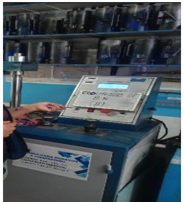
Fotografía 20: ensayo de compresión de concreto en probeta cilíndrica 4%-III
