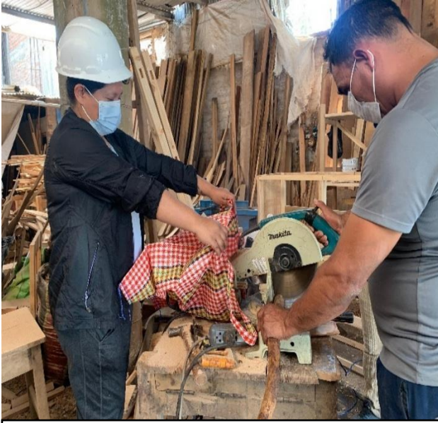
Fotografía 1: extracción de fibra de polylepis flavipila con sierra circular
