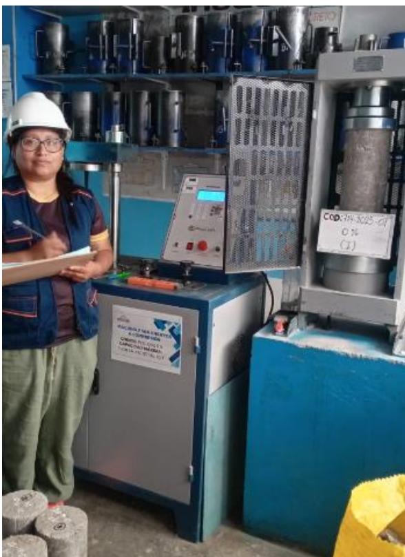
Fotografía 7: ensayo de compresión de concreto en probeta cilíndrica 0%-I
