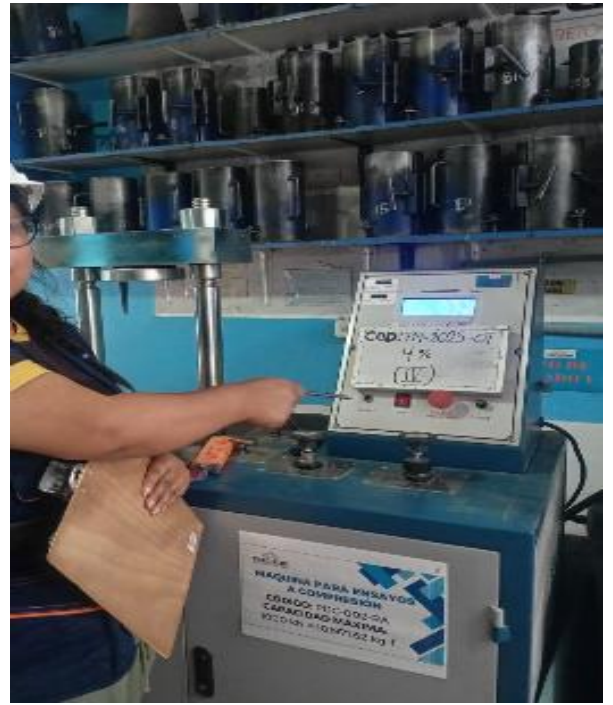
Fotografía 18: ensayo de compresión de concreto en probeta cilíndrica 4%-IV
