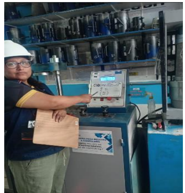
Fotografía 12: ensayo de compresión de concreto en probeta cilíndrica 2%-II
