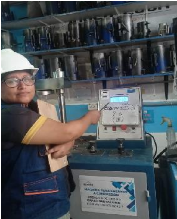
Fotografía 13: ensayo de compresión de concreto en probeta cilíndrica 2%-III
