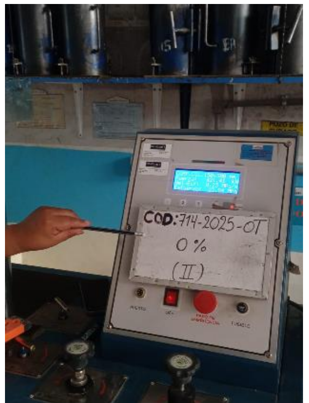
Fotografía 8: ensayo de compresión de concreto en probeta cilíndrica 0%-II
