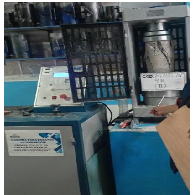
Fotografía 16: ensayo de compresión de concreto en probeta cilíndrica 4%-II
