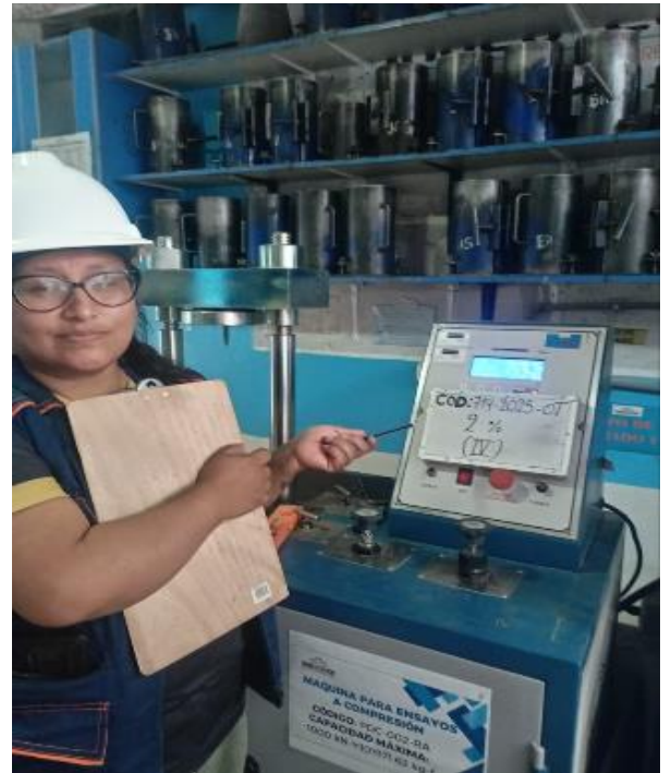
Fotografía 14: ensayo de compresión de concreto en probeta cilíndrica 2%-IV
