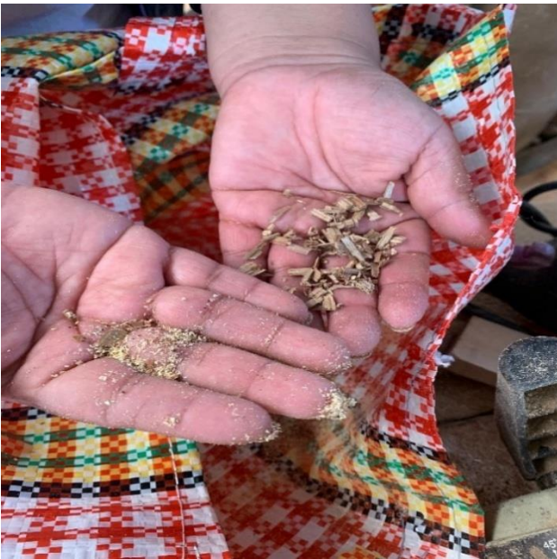
Fotografía 3: resultados de la extracción de fibra de polylepis flavipila, de longitud aprox. Entre 02 mm a 30 mm.
