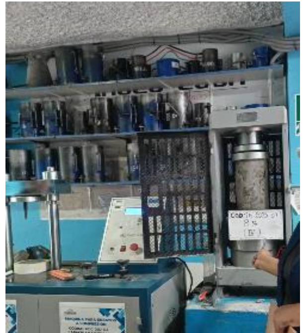
Fotografía 22: ensayo de compresión de concreto en probeta cilíndrica 8%-IV
