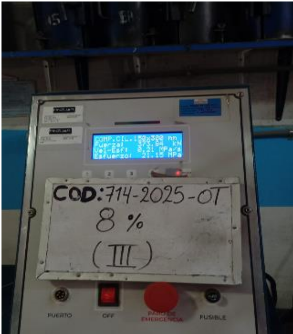
Fotografía 21: ensayo de compresión de concreto en probeta cilíndrica 8%-III
