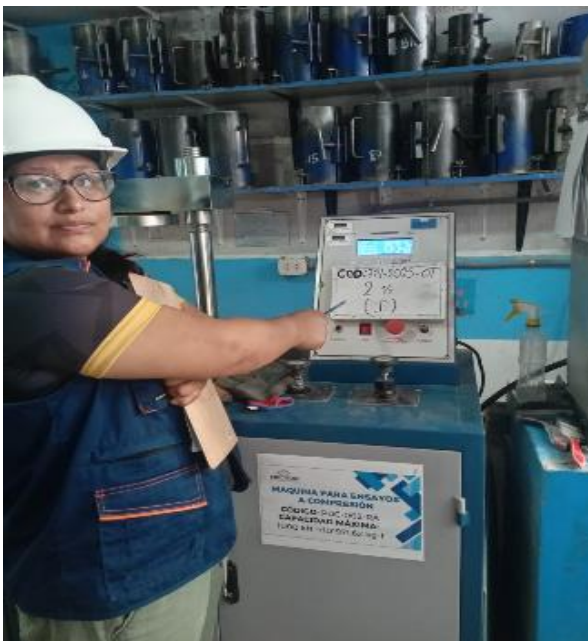
Fotografía 11: ensayo de compresión de concreto en probeta cilíndrica 2%-I
