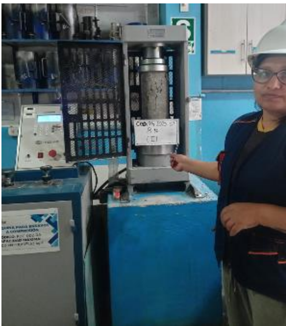
Fotografía 19: ensayo de compresión de concreto en probeta cilíndrica 8%-I
