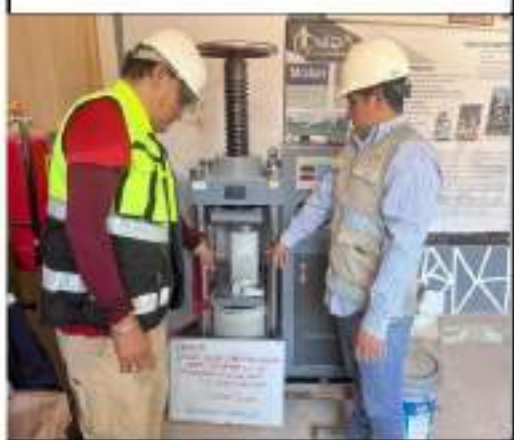
FOTO N°130 SE OBSERVA LA FALLA DEL TESTIGO DE CONCRETO
