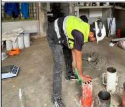
FOTO N°13. SE OBSERVA AL PERSONAL TECNICO GOLPEANDO EL MOLDE CON EL MARTILLO DE GOMA PARA RETIRAR LAS BUBULAS DE AIRE
