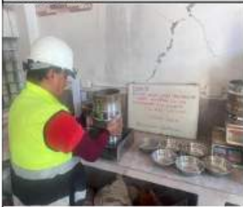
FOTO N°03: SE OBSERVA AL PERSONAL TECNICO REALIZANDO EL TAMIZADO DE LA MUESTRA
