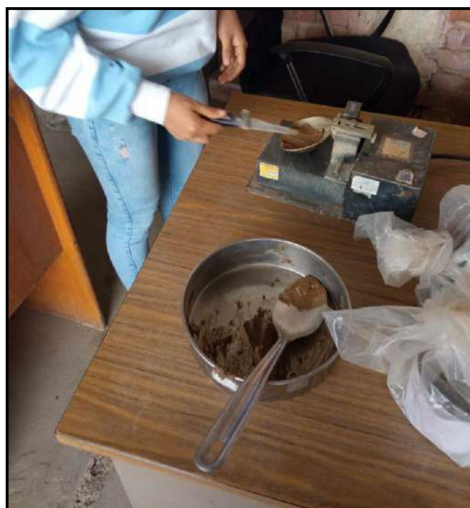
Evidencia Fotográfica N°14: Limite de Atterberg C-01, C-02, C-03 Y C-04
