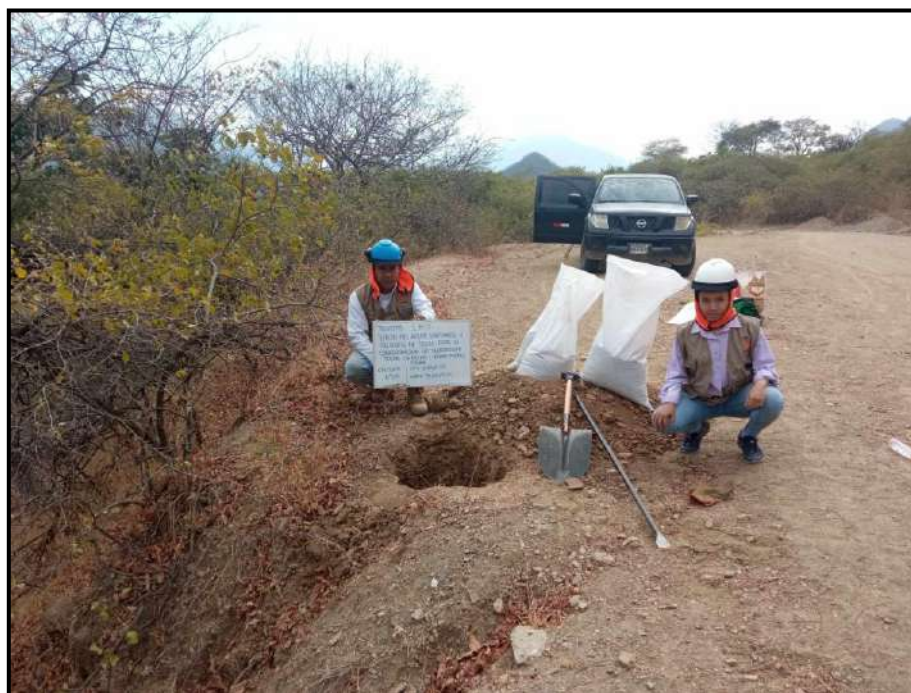
Evidencia Fotográfica N°07: Realización de la toma de muestra de la calicata N°04
