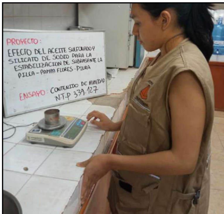
Evidencia Fotográfica N°12: Contenido de humedad C-01, C-02, C-03 Y C-04
