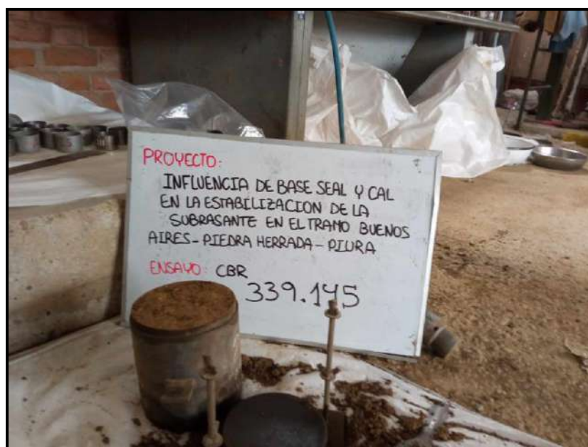
Evidencia Fotográfica N°18: Ensayo de CBR 25 golpes en cada 5 capas para la calicata 01, 02, 03 y 04
