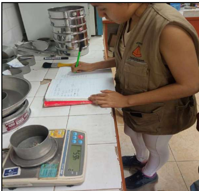
Evidencia Fotográfica N°09: Ensayo de granulometría C-01, C-02, C-03 Y C-04
