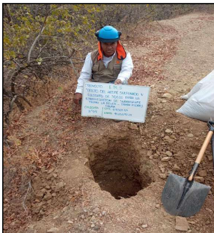
Evidencia Fotográfica N°08: Realización de la toma de muestra de la calicata N°04
