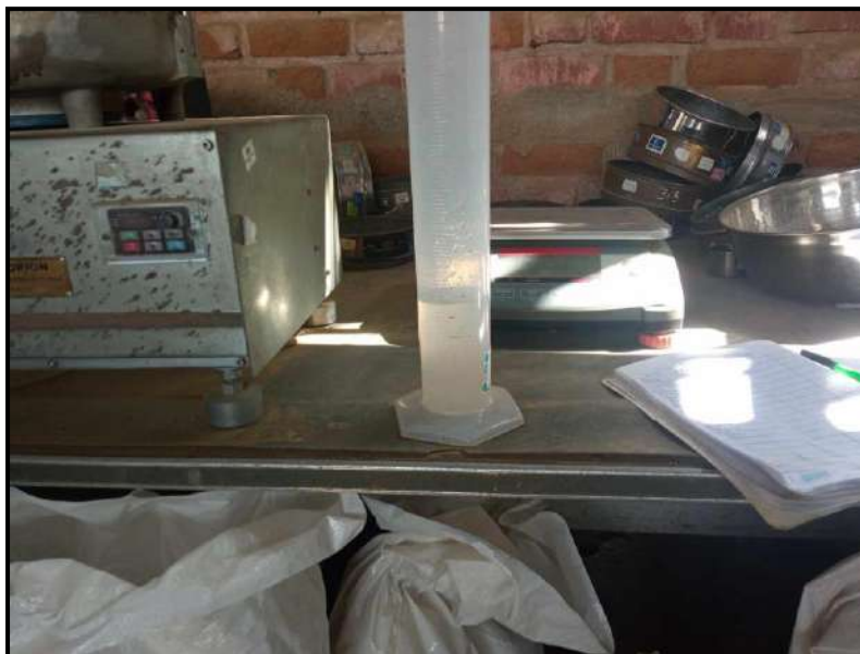
Evidencia Fotográfica N°23: Proctor modificado para la calicata 01, 02, 03 y 04 con Adicion de Aceite Sulfonado 0.13 l/m 3 , 0.27 l/m 3 , 0.31 l/m 3 y Silicato de Sodio 1.5%, 3.0%, 4.5%
