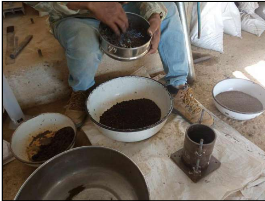
Evidencia Fotográfica N°22: Proctor modificado para la calicata 01, 02, 03 y 04 con Adicion de Aceite Sulfonado 0.13 l/m 3 , 0.27 l/m 3 , 0.31 l/m 3 y Silicato de Sodio 1.5%, 3.0%, 4.5%
