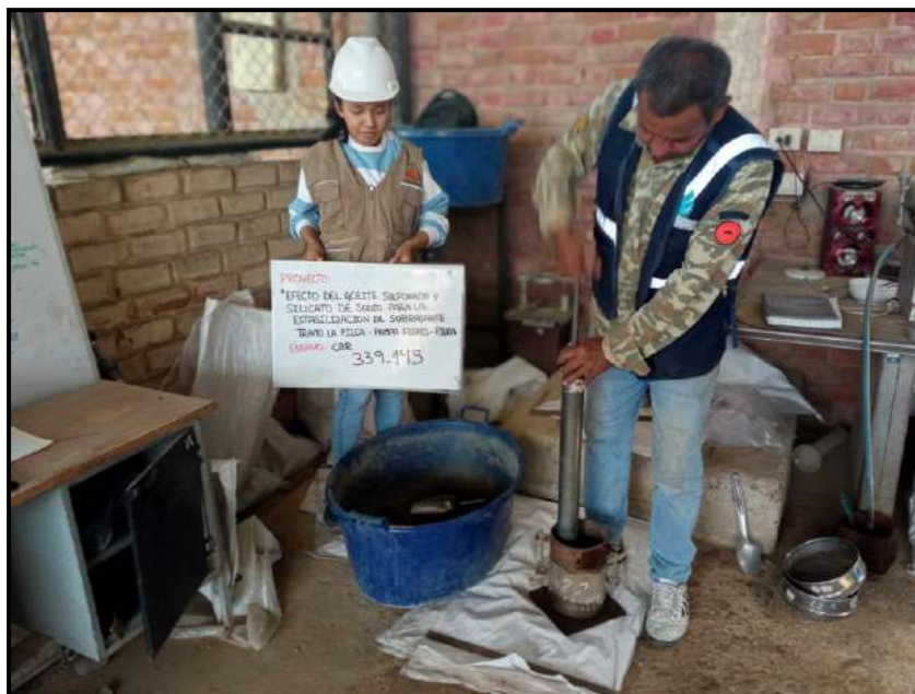
Evidencia Fotográfica N°18: Ensayo de CBR 25 golpes en cada 5 capas para la calicata 01, 02, 03 y 04
