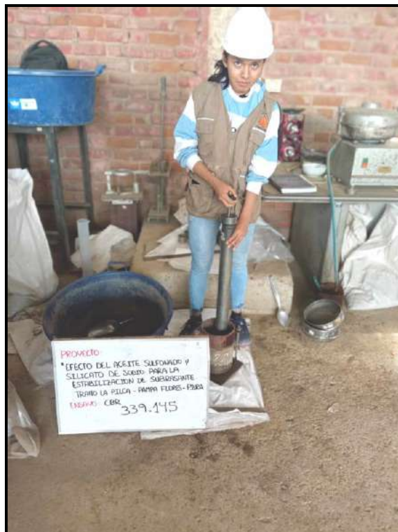
Evidencia Fotográfica N°16: Ensayo de CBR 25 golpes en cada 5 capas para la calicata 01, 02, 03 y 04
