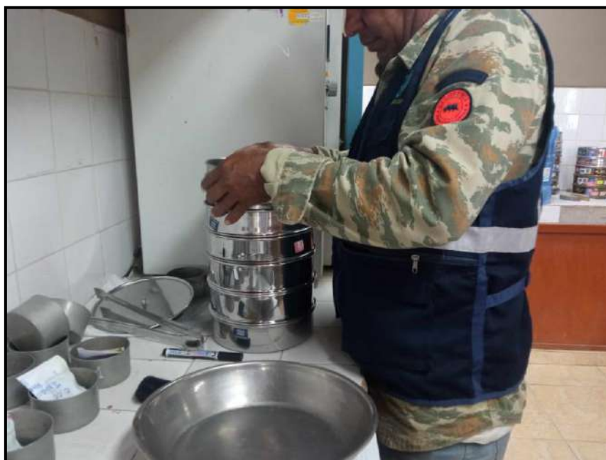
Evidencia Fotográfica N°10: Ensayo de granulometría C-01, C-02, C-03 Y C-04
