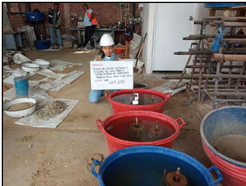
Evidencia Fotográfica N°19: Ensayo de CBR 25 golpes en cada 5 capas para la calicata 01, 02, 03 y 04
