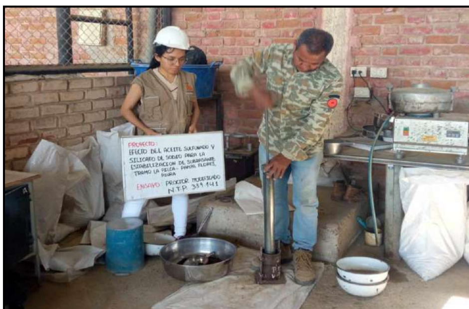
Evidencia Fotográfica N°24: Proctor modificado para la calicata 01, 02, 03 y 04 con Adicion de Aceite Sulfonado 0.13 l/m 3 , 0.27 l/m 3 , 0.31 l/m 3 y Silicato de Sodio 1.5%, 3.0%, 4.5%
