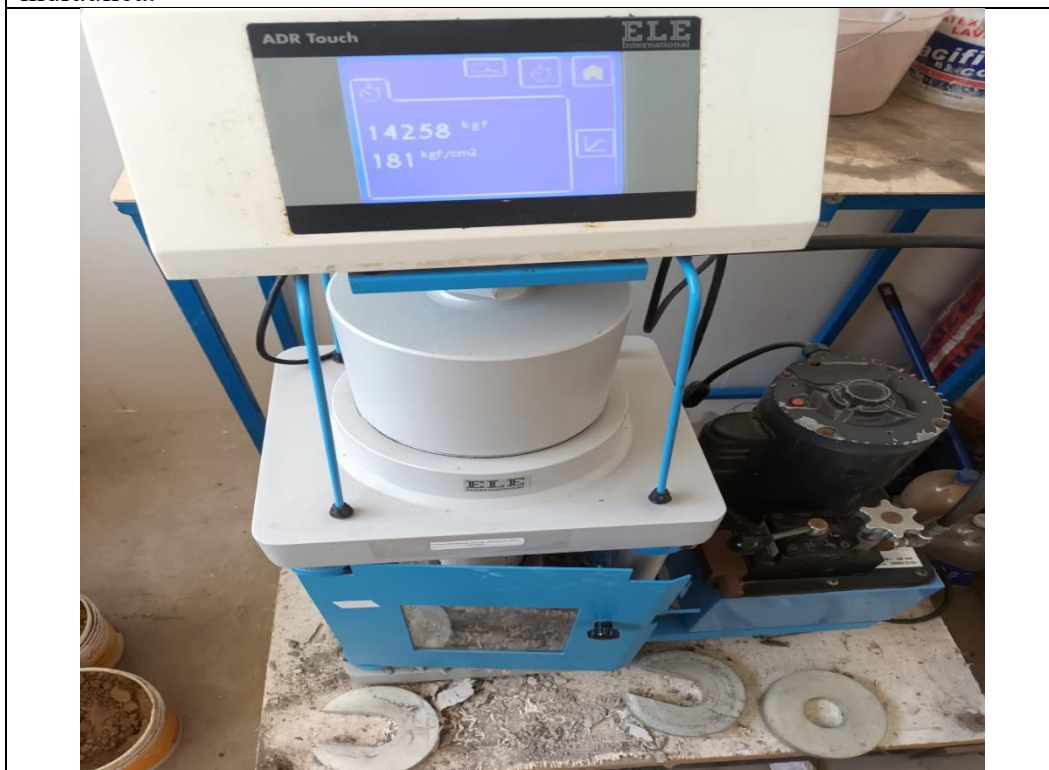
FOTO 12: Ensayo de resistencia a la compresión de la probeta de concreto con adición de 0.25% de vexilo de plumas de pollo, mediante el uso de prensa hidráulica.
