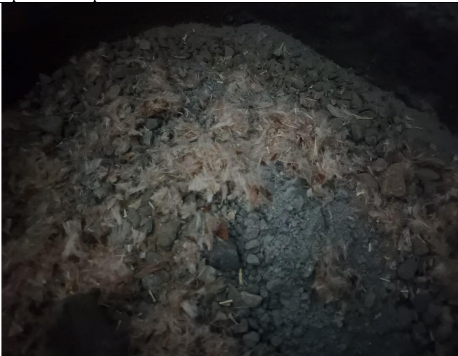
FOTO 06: Proceso de mezclado de los materiales del concreto, incorporando el vexilo de plumas de pollo en los porcentajes establecidos, con la finalidad de obtener una mezcla homogénea.
