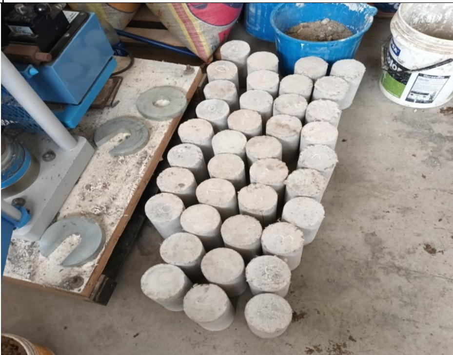
FOTO 08: Probetas de concreto elaboradas en moldes cilíndricos, con el proceso de curado culminado, dispuestas para la realización del ensayo de resistencia a la compresión.
