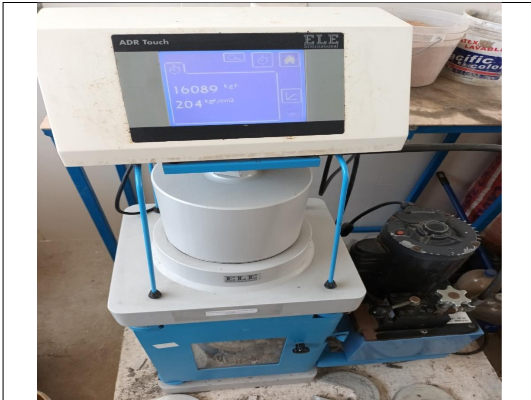
FOTO 11: Ensayo de resistencia a la compresión de la probeta de concreto con adición de 0.125% de vexilo de plumas de pollo, mediante el uso de prensa hidráulica.
