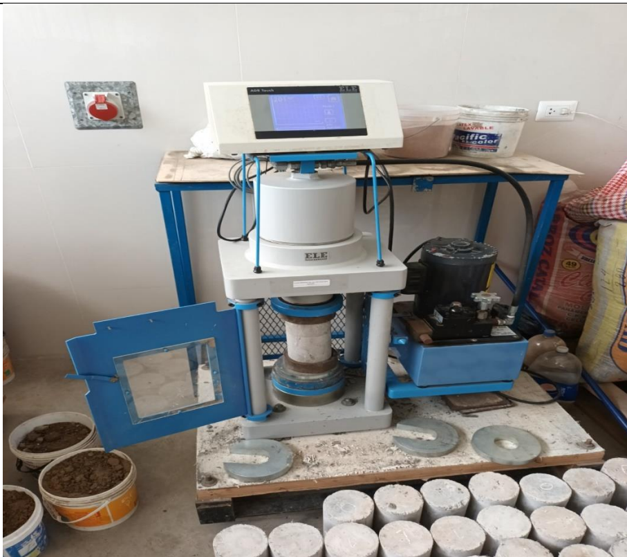
FOTO 09: Ensayo de resistencia a la compresión de la probeta patrón de concreto, mediante el uso de prensa hidráulica.
