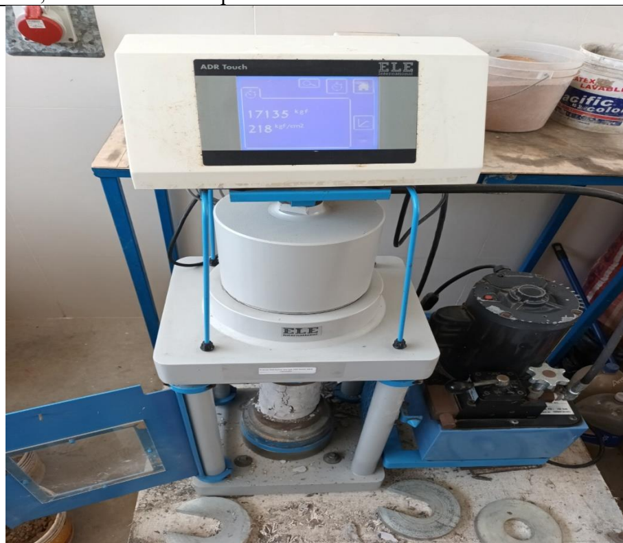
FOTO 10: Ensayo de resistencia a la compresión de la probeta de concreto con adición de 0.125% de vexilo de plumas de pollo, mediante el uso de prensa hidráulica.
