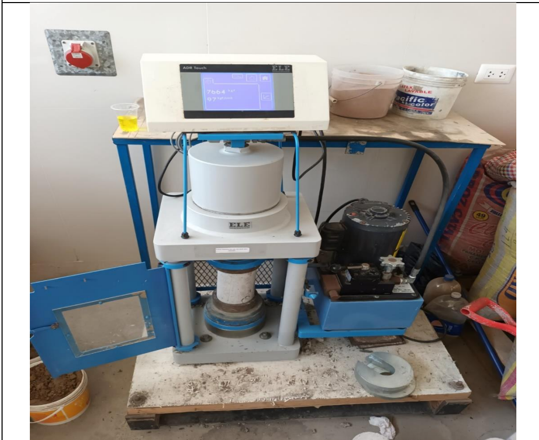
FOTO 14: Ensayo de resistencia a la compresión de la probeta de concreto con adición de 0.50% de vexilo de plumas de pollo, mediante el uso de prensa hidráulica.
