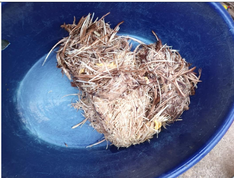
FOTO 01: Proceso de lavado del vexilo de plumas de pollo previo a su incorporación en la mezcla de concreto, con la finalidad de eliminar impurezas y garantizar su adecuada utilización como material de refuerzo.
