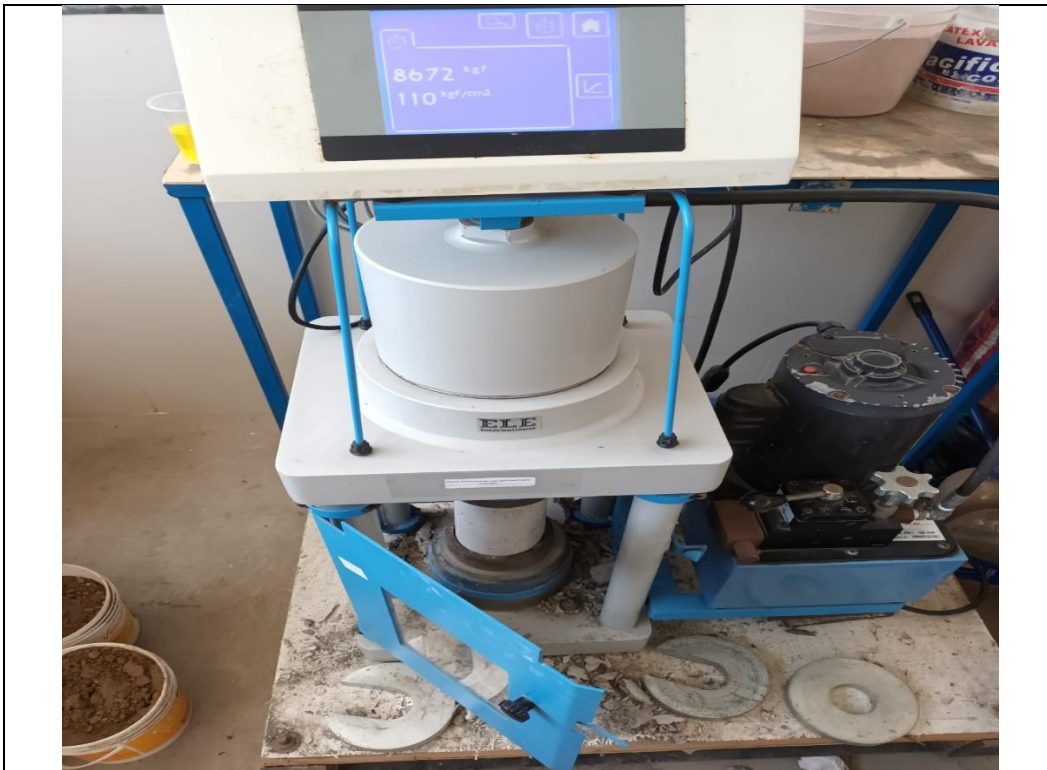
FOTO 13: Ensayo de resistencia a la compresión de la probeta de concreto con adición de 0.50% de vexilo de plumas de pollo, mediante el uso de prensa hidráulica.
