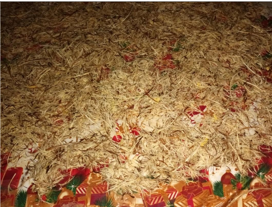
FOTO 02: Proceso de secado del vexilo de plumas de pollo en condiciones ambientales, con la finalidad de reducir la humedad del material antes de su incorporación en la mezcla de concreto.
