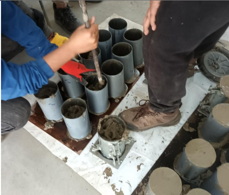
FOTO 07: Proceso de llenado de los moldes cilíndricos con la mezcla de concreto fresco, asegurando una adecuada compactación para la elaboración de las probetas.
