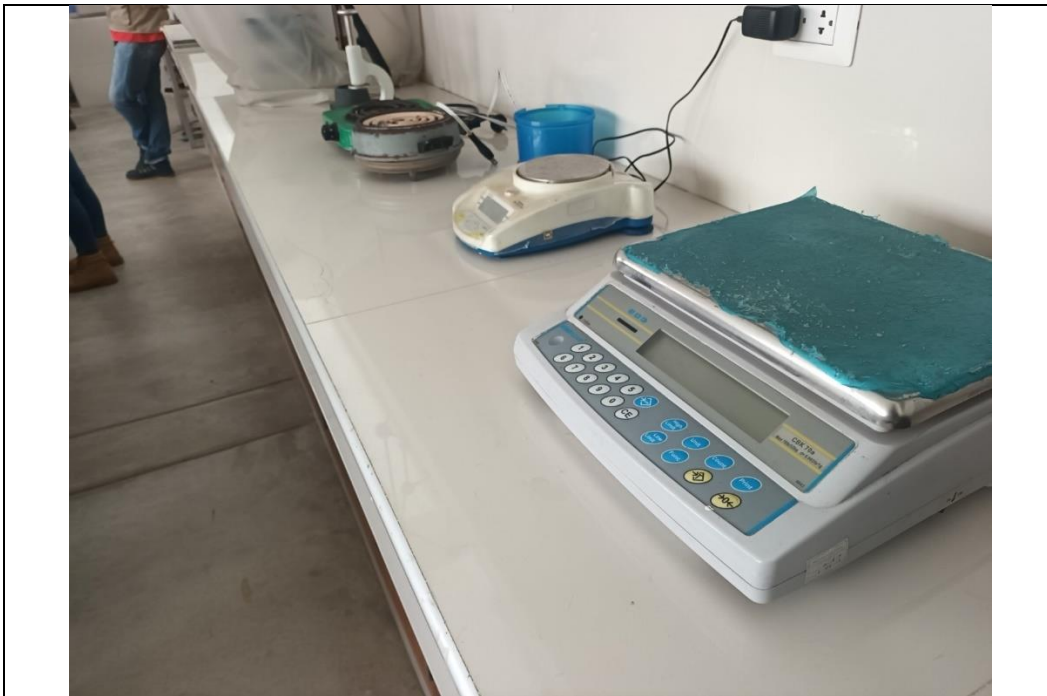
FOTO 03: Proceso de dosificación de los materiales mediante el uso de balanza digital, considerando los porcentajes de vexilo de plumas de pollo (0.125%, 0.25% y 0.50%) para la elaboración del concreto.
