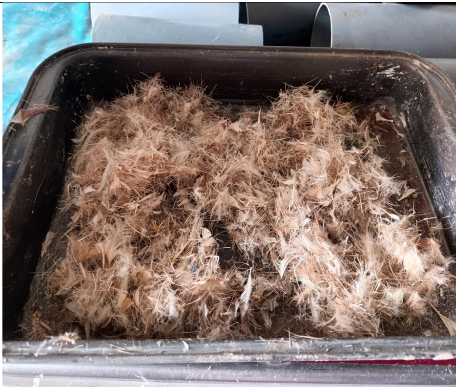
FOTO 05: Vexilo de plumas de pollo previamente dosificado y acondicionado, listo para su incorporación en la mezcla de concreto.
