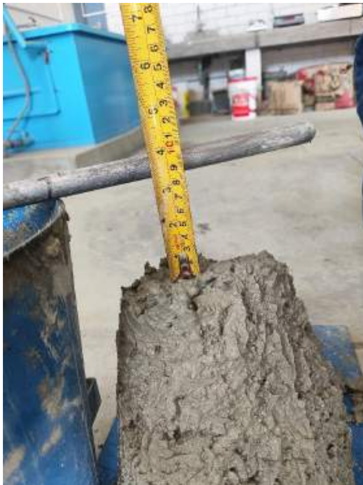
Ensayo de Asentamiento (Slump Test) del Concreto Fresco
