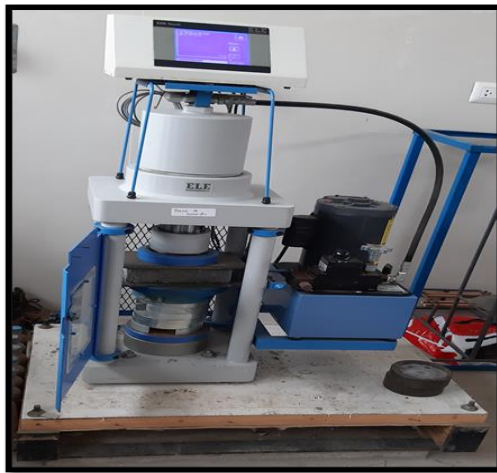
Máquina de Resistencia a la Compresión
