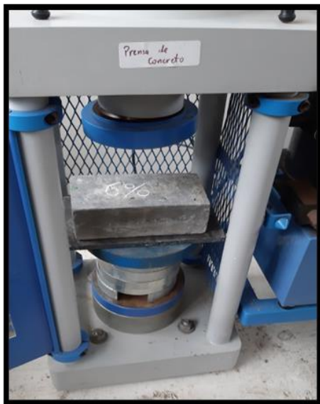
Prueba de resistencia de los adoquines con plástico PET reciclado
