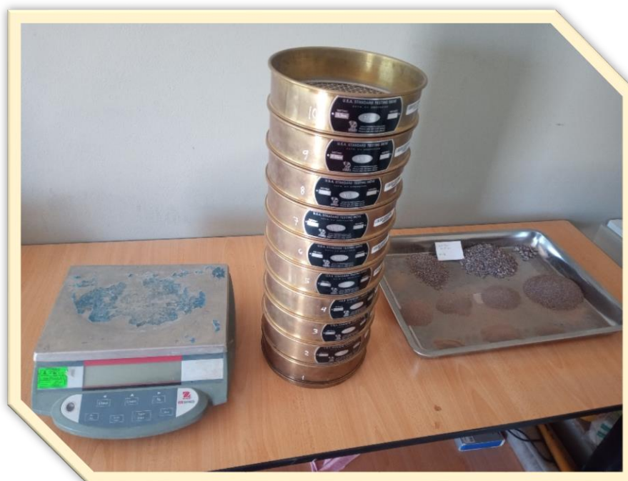
Fotografía 1: Análisis granulométrico de agregado fino.
