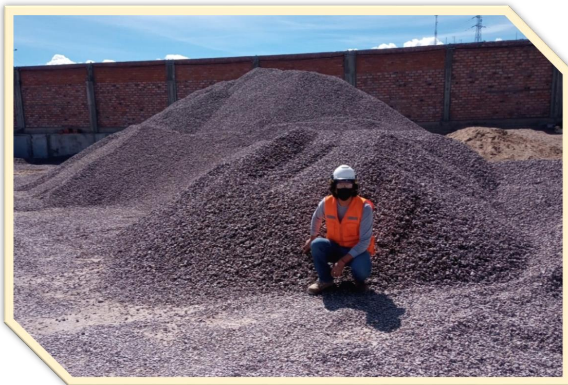
Fotografía 3: Deposito de agregado grueso empleado en la producción de concreto premezclado en la empresa TECNYCON SAC.
