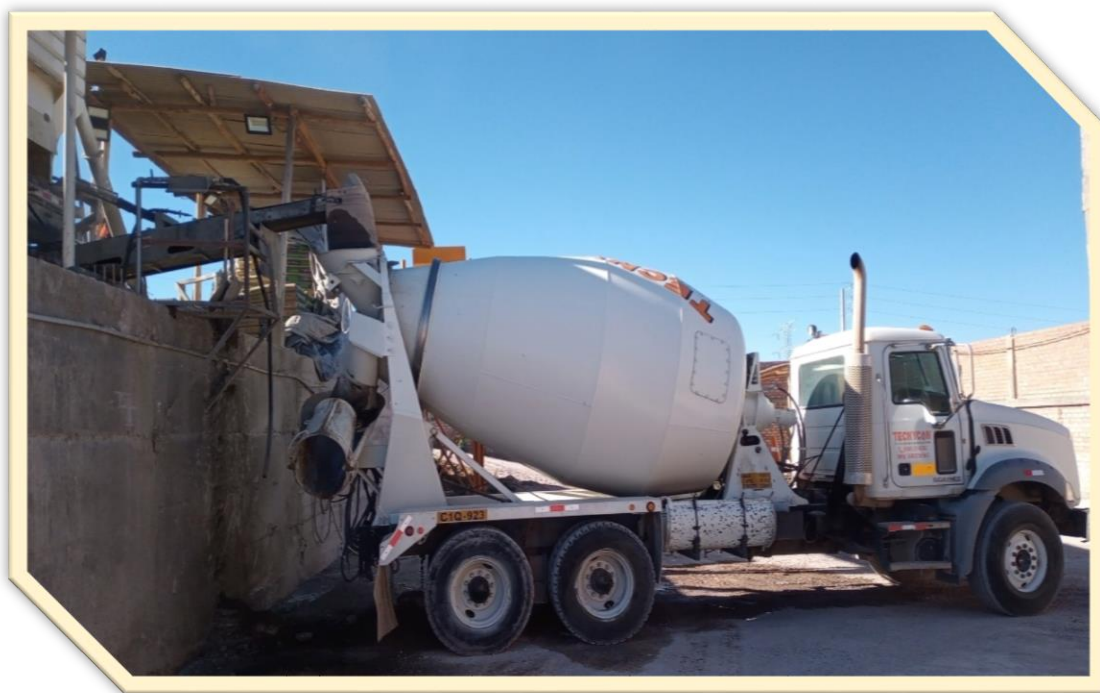
Fotografía 5: Carguío de concreto premezclado al mixer en la empresa TECNYCON SAC.
