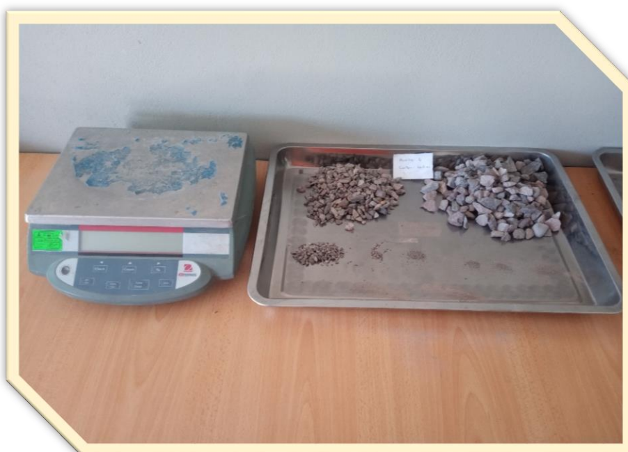
Fotografía 2: Análisis granulométrico de agregado grueso
