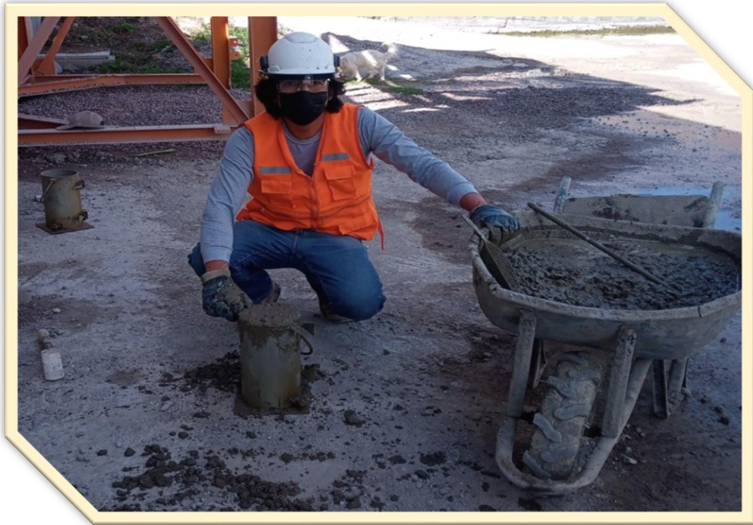
Fotografía 7: Elaboración de probetas de concreto con muestra de concreto premezclado en la empresa TECNYCON SAC.
