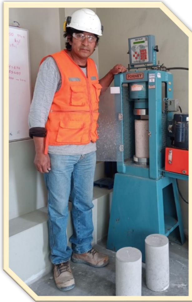
Fotografía 9: Ensayo de resistencia a la compresión en la empresa TECNYCON SAC.
