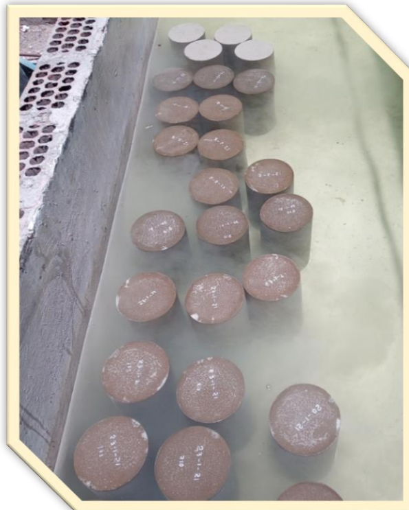
Fotografía 8: Curado de probetas de concreto en la empresa TECNYCON SAC.
