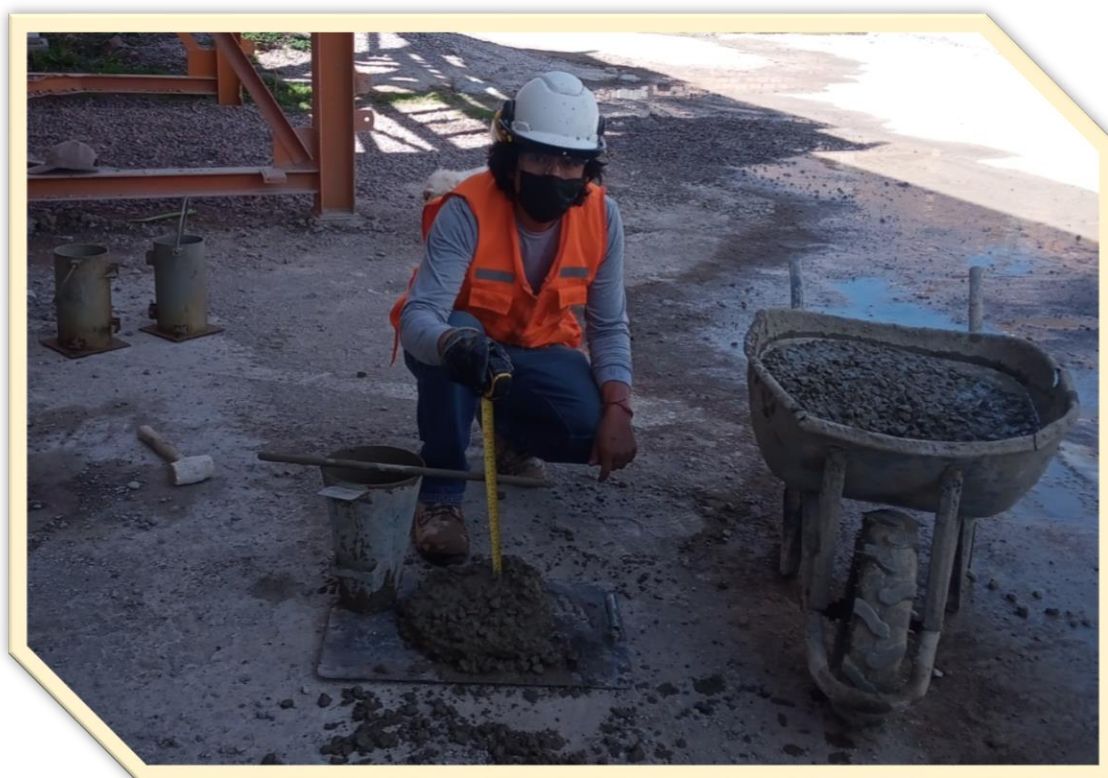
Fotografía 6: Ensayo de fluidez del concreto de muestra de concreto premezclado en la empresa TECNYCON SAC.
