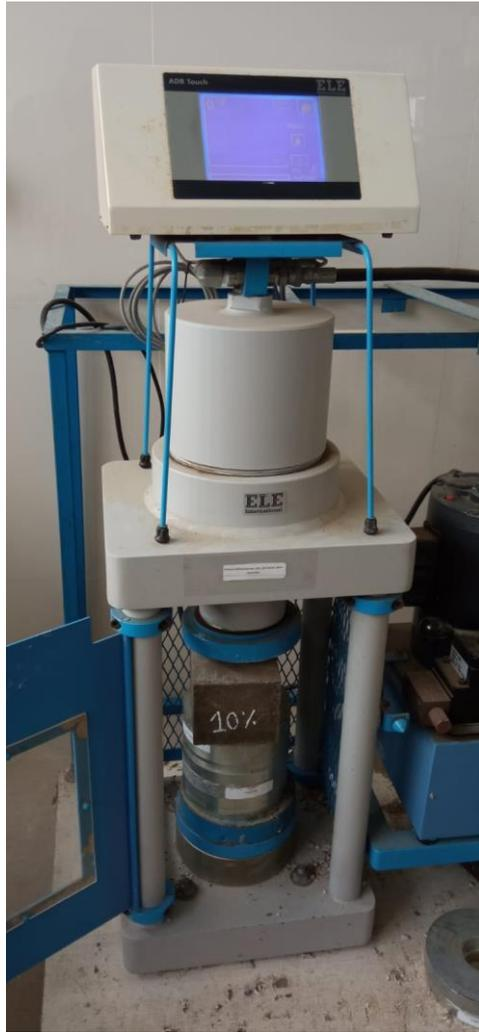
Rotura de probetas 10%
