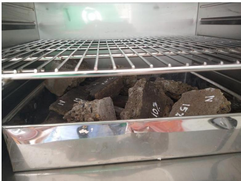
Probetas secando en la estufa
