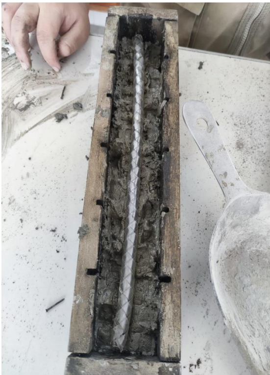
Elaboración de probetas con las varilla de PET reciclado trenzado y varilla de acero
