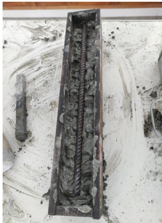
Elaboración de probetas con las varilla de PET reciclado trenzado y varilla de acero
