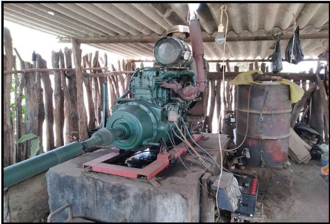
Imagen 6. Motor petrolero, la cual cuenta con mas de 22 años antigüedad, su función es extraer el agua y llevarla hasta su punto de almacenamiento.
