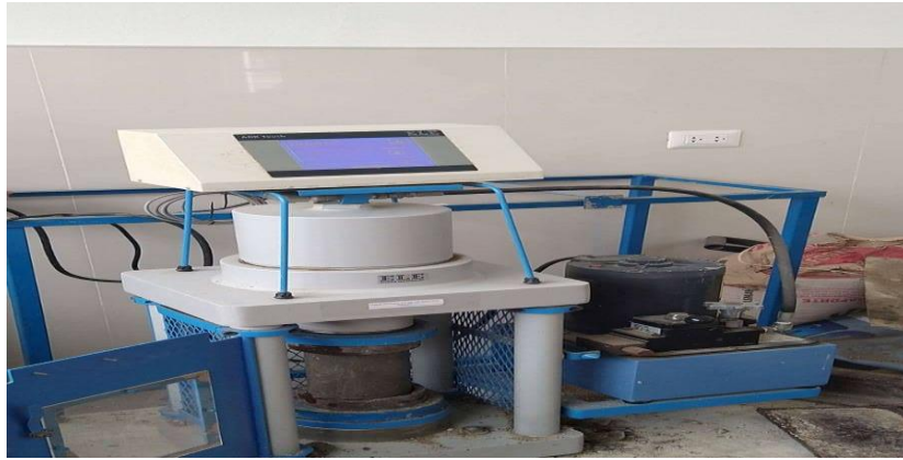
Ensayo de la resistencia a la compresión
