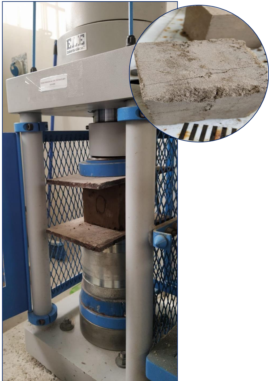
Proceso de rotura de ladrillos con compresor hidráulico
