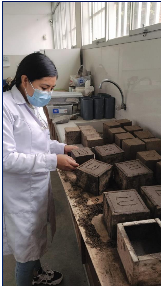
Proceso de desencofrado y secado.
