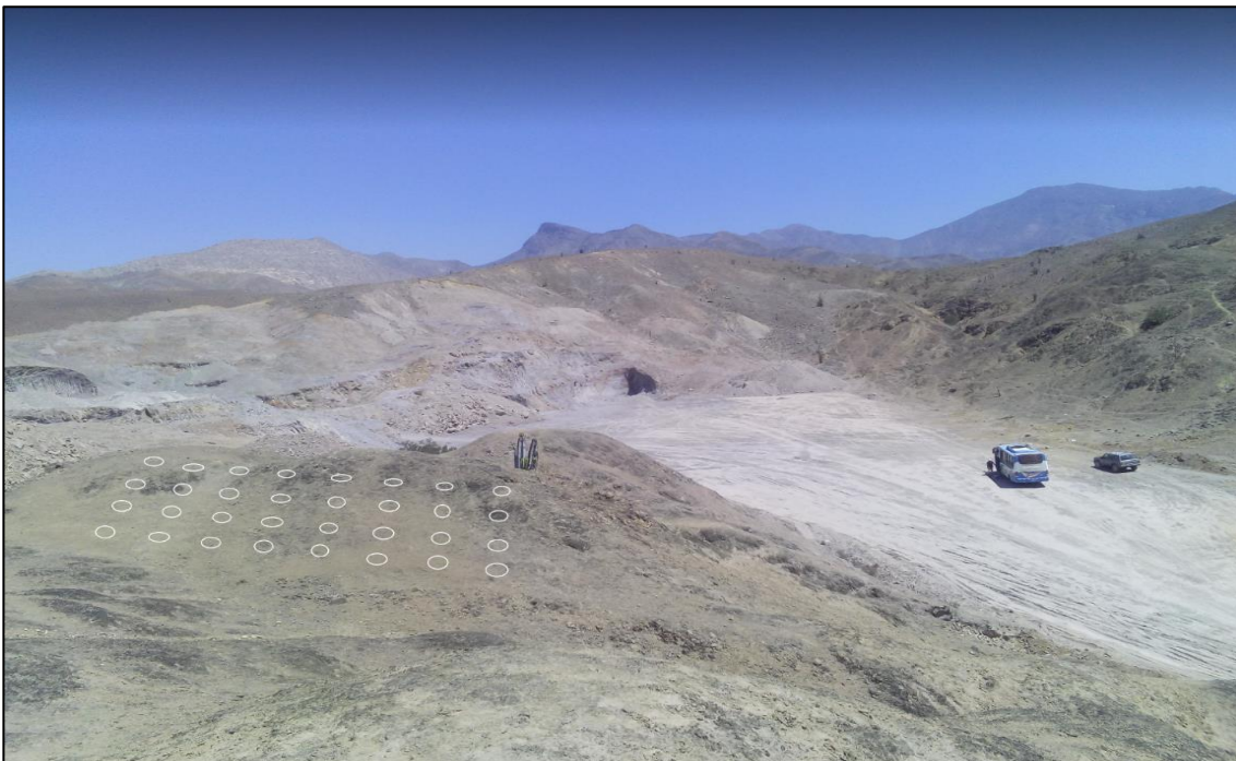
Referencia de la malla realizada en el talud de banco
