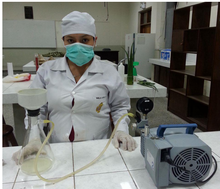
Filtrando el líquido al vacío utilizando papel de filtro Whatman # 1, del cual se obtiene el extracto hidroetanólico
