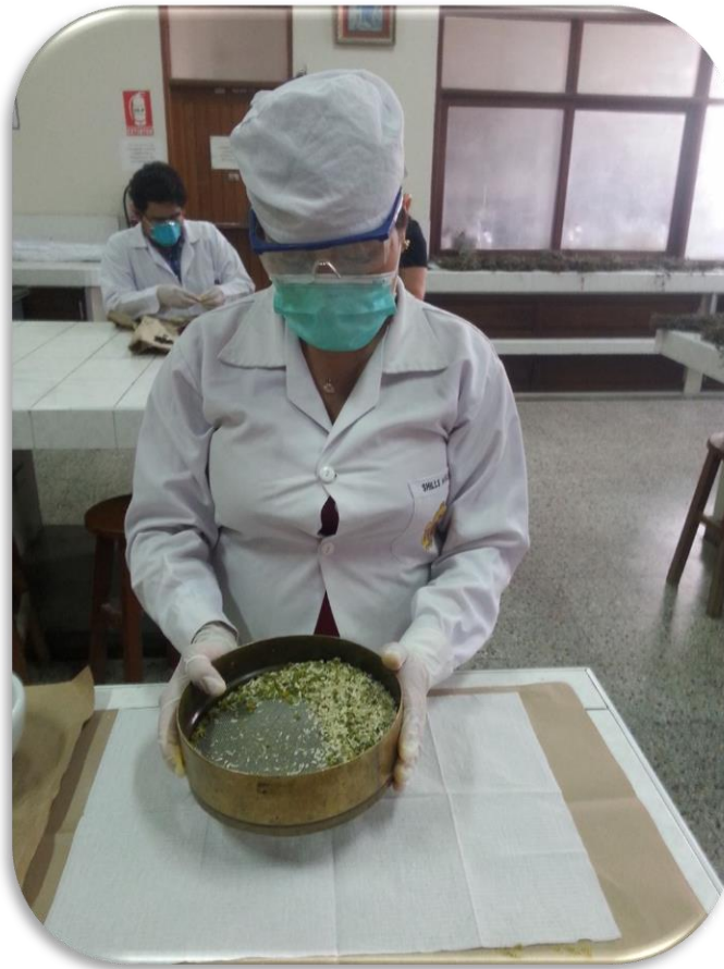
Tamizaje de las flores de manzanilla pulverizadas a través del tamiz de malla N° 20.
