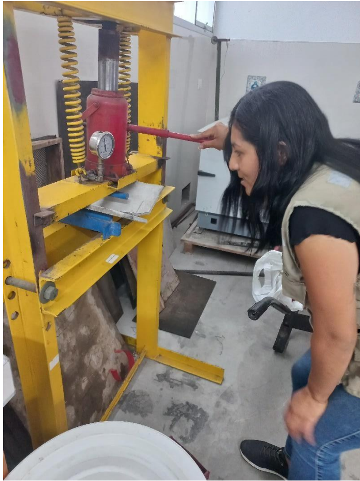
Rompiendo paneles a flexión
