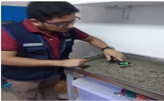
Figura 29.- medida de temperatura de concreto en estado fresco.
