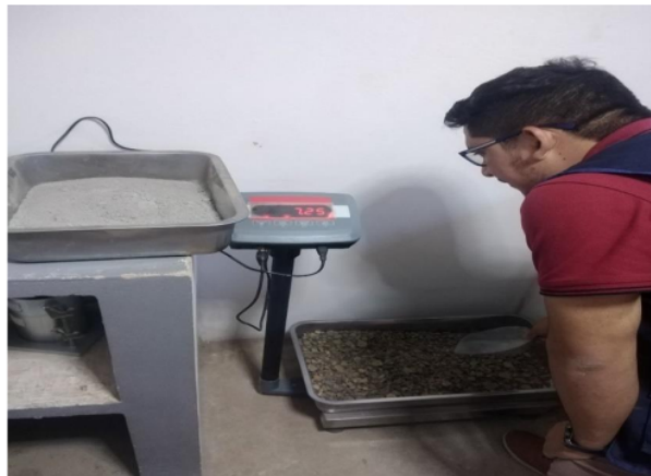
Figura 21- Balanza 29 de mayor dimensión usada para el tamizaje del agregado grueso
