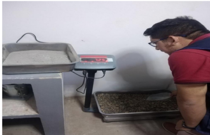
Figura 27.- peso de agregado grueso para el diseño de mezcla.
