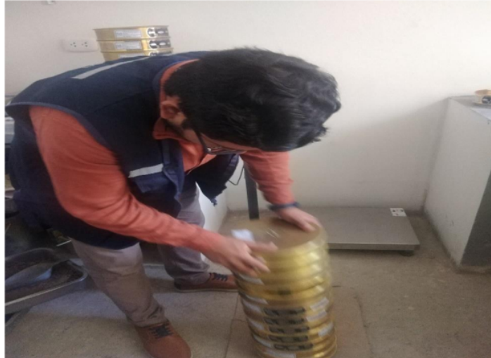
Figura 25.- proceso de tamizado de agregado grueso.
