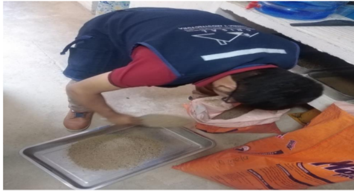
Figura 28.- peso de agregado fino para diseño de mezcla.
