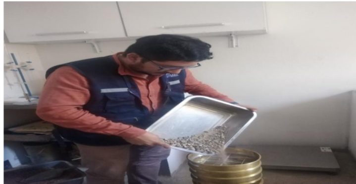
Figura 26.- proceso de tamizado de agregado fino.
