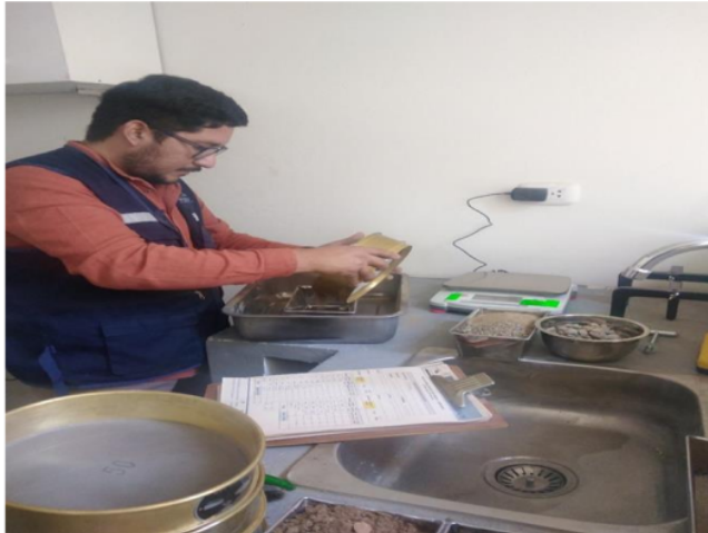
Figura 20- Balanza de menor dimensión usada para el tamizaje 27 del agregado fino
