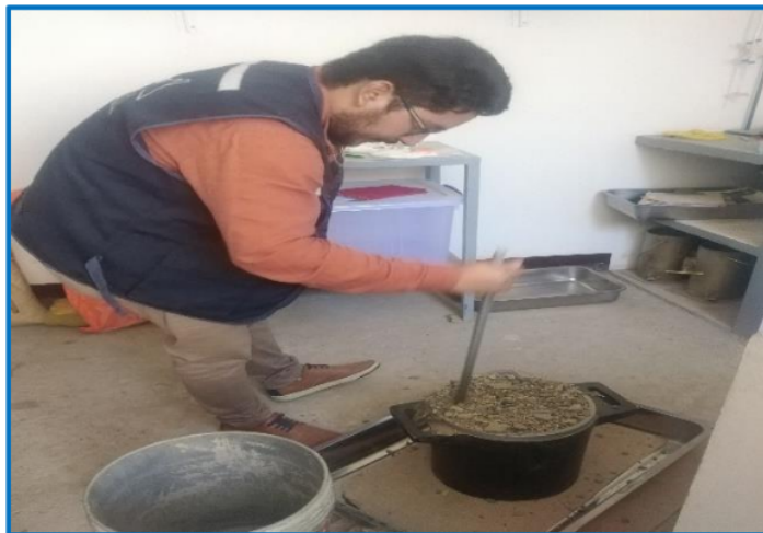
Figura 11. Muestra apisonada con 25 golpes mediante una varilla lisa
