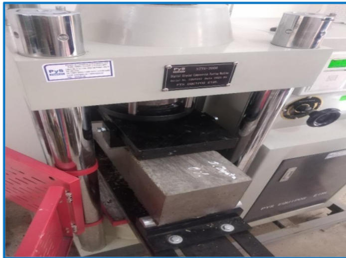
Figura 15. Espécimen puesto a tenacidad a la flexibilidad
