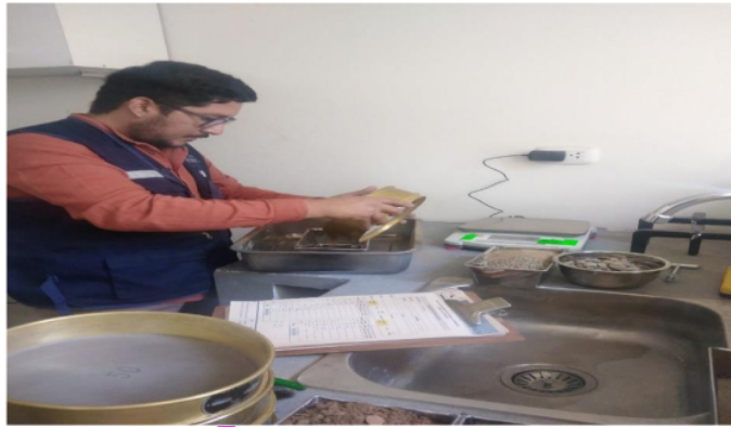
Figura 24.- proceso de tamizado de agregado grueso.
