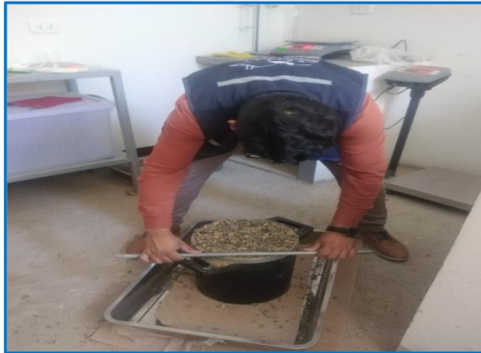
Figura 10. Enrazado de adicionado grueso
