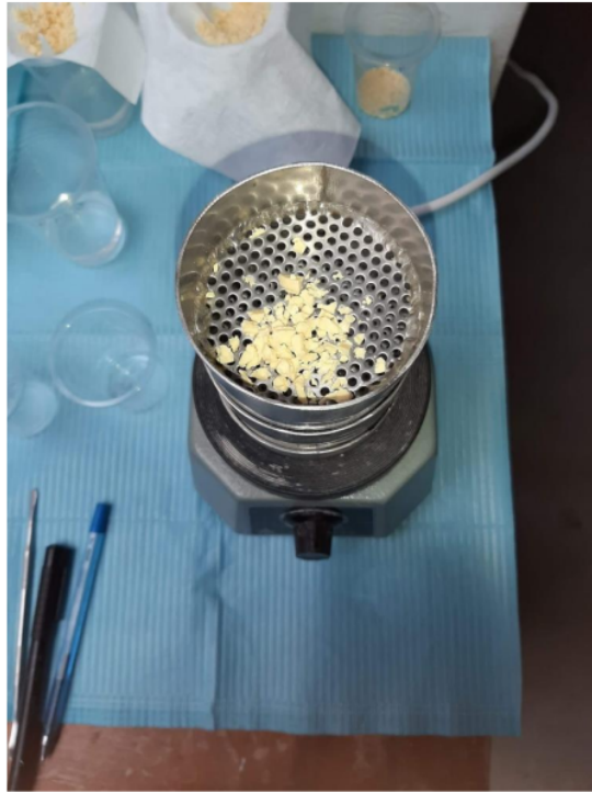
Tamizador colocado en el vibrador
